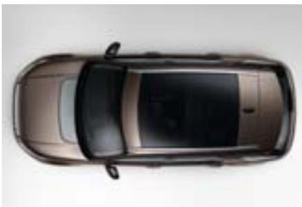
Die Dachreling ist die Voraussetzung, um Lasten auf dem Dach des Discovery Sport zu transportieren. Es handelt sich um eine flache Aluminiumschiene, in deren Profil verschiedene Trägersysteme, wie z. B. die Dachquerträger oder der Expedition-Dachgepäckträger, befestigt werden können. Die Befestigungspunkte am Fahrzeug sind vorbereitet. Die Ladekapazität beträgt 75 kg (höchstzulässige Traglast entspricht der Höchsttragelast der Dachtransportsysteme). Die Reling ist auch in einer kurzen
