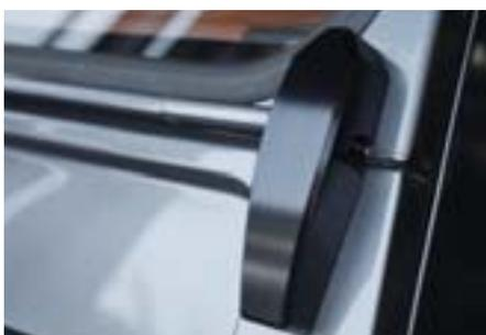
Wir empfehlen Ihnen die enorm stabilen Scheibenrahmenhalter aus hochfestem Flugzeug-Aluminium. Die Optik ist originalgetreu, die Sicherheit bei möglichen Unfällen erhöht. Die Scharniere sind schwarz eloxiert, was in Verbindung mit dem Edelstahl-Montage-Satz einen optimalen Korrosionsschutz bietet. Die Scheibenrahmenhalter werden in Schwarz geliefert. Edelstahl-Schrauben und Dichtungen sind im Lieferumfang enthalten. Bitte geben Sie bei Ihrer Bestellung die ge-
