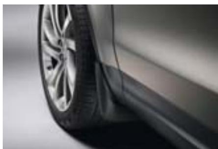
Schmutzfänger reduzieren das Spritzwasser und schützen den Lack vor Verschmutzungen. Speziell in das Exterieur-Design des Fahrzeugs integriert. Ausführung als Fahrzeug-Set. Montage 15 AW.
