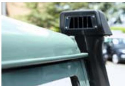
Dieses eckig geformte Lufteinlassrohr aus Kunststoff ist eine optisch modernere Alternative zu dem klassischen Land Rover-Lufteinlass mit Zyklon-Filter, jedoch ohne der Funktion der Zentrifugalabscheidung. Es müssen zur Befestigung zwei Löcher in den Kotflügel gebohrt werden. Montage 22 AW.
