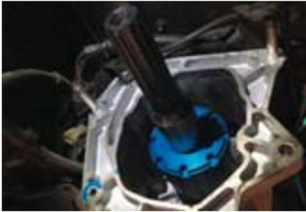
Seit Auslieferung der ersten Defender TD4 2.4 mit neuem MT82-Getriebe treten immer wieder Probleme mit der Zwischenwelle auf. Grund hierfür ist die nicht vorhandene Schmierung, welche zu einem überdurchschnittlichen Verschleiß sowie einem daraus resultierenden Abriss führen kann. Auf Reisen ist ein solcher Schaden besonders problematisch, da eine Weiterfahrt unmöglich wird. Um beschriebenen Szenario vorzubeugen, bieten wir unsere ölgeschmierte Zwischen-
