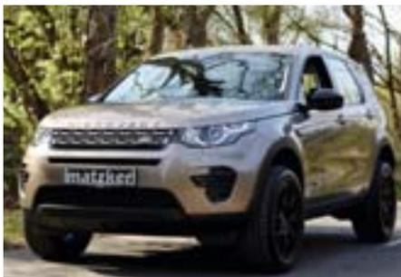
Die wichtigsten Produkte zur Verbesserung des Discovery Sport mit dem optimalen Preis-Gegenwert bekommen Sie im RX4-Paket: Mit dem Suspension Kit Höherlegung wird das Fahrzeug um 35 mm höhergelegt. Unsere Leichtmetall-Spurverbreiterung ergänzt das optimale Fahrverhalten und bildet eine perfekt abgestimmte Einheit, welche den Discovery Sport im Geländeeinsatz noch überlegener macht. Unsere Leistungssteigerung vermittelt in diesem Zusammenhang,
