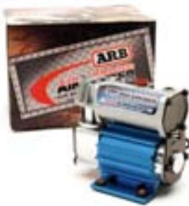
Der Kompressor liefert den erforderlichen Betriebsdruck von 8 Bar für die 100%-Differentialsperre. Es können eine oder zwei Sperren angesteuert werden. Zusätzlich kann ein Reifenfüllschlauch angeschlossen werden. Die Qualität dieses Kompressors ist außerordentlich hoch, zur Befüllung von Reifen sollte er jedoch nur in Ausnahmefällen eingesetzt werden. Der Einbauaufwand hängt vom Einbauort ab, mit elektrischem Anschluss, Schaltereinbau sowie der Verlegung der Luftleitungen ab
