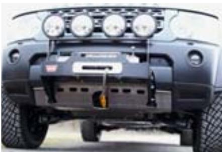
Dieser originale Land Rover-Leichtmetall-Unterfahrschutz schützt den Frontbereich Ihres Discoverys zuverlässig. Er ist aus 6-mm-Leichtmetall gefertigt und ersetzt die empfindlichen Kunststoffteile in diesem Bereich. Montage 14 AW.
