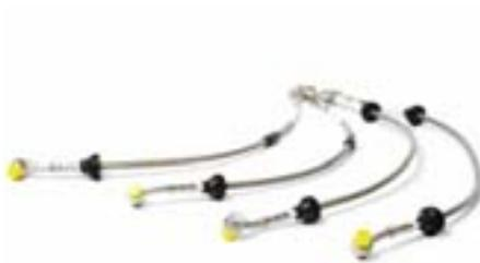
Die serienmäßig verbauten Gummibremsleitungen mit Gewebeverstärkung dehnen sich bei einem entsprechenden Druckanstieg aus, was eine Reduzierung des Bremsdrucks zur Folge hat. Im Pedal ist ein schwammiges Gefühl feststellbar. Die hochwertigen Stahlflex-Bremsleitungen sind durch den Aufbau mit einer inneren Teflon-Leitung, die von Edelstahlgewebe ummantelt ist, dehnungsresistent und extrem druckfest. Durch den Einbau wird der Druckpunkt präziser und das
