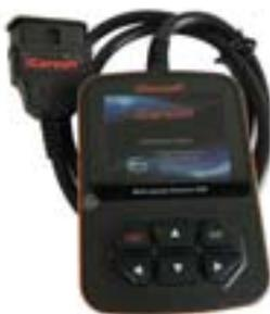
Mit diesem OBD-II-Diagnosegerät können Sie die wesentlichen Fehlermeldungen in der Motor- und Fahrwerksteuerung auslesen und löschen. Das kann sehr wichtig sein, da z. B. Störungen in der Ladedrucksteuerung einen dauerhaften Notlauf-Modus hervorrufen können, der die Motorleistung wesentlich reduziert. Auf einer Fernreise, eventuell mit schwer beladenem Fahrzeug in den Dünen, ist dann eine Weiterfahrt unmöglich. Nach dem Löschen des Fehlers ist der normale
