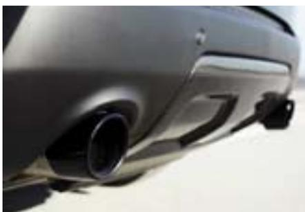
Mit diesen schwarzen Endrohrblenden verleihen Sie Ihrem Range Rover Sport den optischen Endschliff. Das Ergebnis: ebenso sportlich wie edel. Der serienmäßige Auslassumfang mit einem Durchmesser von 80 mm wird formschön vergrößert. Die Oberfläche dieses Bauteils wird nachträglich schwarz pulverbeschichtet. Neben einer beeindruckenden Optik wird das Produkt so bestmöglich gegen Korrosion und Witterungseinflüsse geschützt. Die Beschichtung versteht sich
