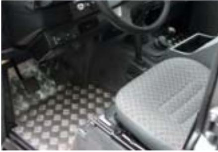
Für Fahrzeuge, deren Innenraum stark beansprucht wird, bieten wir eine Auskleidung des Fußraumes aus Leichtmetall-Riffelblech an. Die Bleche werden passgenau geschnitten und kleiden den Fußraum aus. Nach unten erfolgt die Abdichtung durch Moosgummi. Die Materialstärke beträgt 5 mm inkl. der Riffel. Pflegeleichter geht es nicht! Bitte geben Sie uns bei einer Bestellung das Modell an. Der Lieferumfang beträgt ein rechtes und ein linkes Blech. Montage 19 AW.
