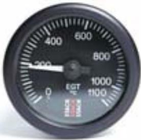
Mit dem Pyrometer wird die Gastemperatur zwischen Zylinderkopf und Turbolader erfasst. Nur diese Messung gibt Aufschluss über die tatsächlich thermische Belastung des Motors, da die Wasser- und Öltemperatur einerseits träge und zeitverzögert ansteigt, andererseits der Kühlkreislauf so überdimensioniert ist, dass sich kurzzeitige thermische Überbelastungen im Verbrennungsablauf in der Wassertemperatur nicht bemerkbar machen. Zudem sollte der Turbomotor nie im heißen Zustand abgestellt
