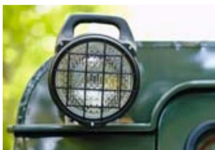
Dieser hochwertige 55-Watt-Halogen-Arbeitsscheinwerfer von Hella hat ein robustes Kunststoffgehäuse und ist allseitig schwenkbar. Er ist lichtstark und hat einen 140-mm-Reflektor. Als Arbeitsscheinwerfer hat er eine Streuscheibe mit Breitenwirkung und ist optimal zur Montage am Heck des Defender geeignet. Der Lieferumfang umfasst den Scheinwerfer, die Leuchtmittel, die Leitungen, ein Relais sowie einen Schalter zur Montage im Innenraum. Montage ab 19 AW.
