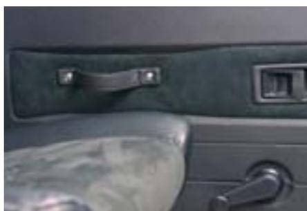
Die flexiblen Leder-Türgriffe werden anstelle der Kunststoffgriffe montiert. Damit entsteht für Fahrer, die mit dem Knie den Türgriff berühren, eine angenehme Vergrößerung des Innenraumes. Die Türschlaufen sind aus weichem Nappaleder gefertigt und mit einer weißen Kappnaht abgesetzt. Der Preis bezieht sich auf ein Paar mit verchromten Befestigungen. Montage 3 AW.
