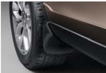
Jeder kennt das Problem: Die Seiten des Discovery Sport verschmutzen stark, wenn durch Nässe und Schlamm gefahren wird. Besonders an den Türgriffen ist dies unangenehm. Sofern der Discovery Sport mit breiteren Reifen oder einer Spurverbreiterung ausgerüstet ist, wird dieser Umstand noch verstärkt. Die Schmutzfänger reduzieren dieses Problem. Sie sind aus robustem Kunststoff hergestellt. Der Lieferumfang beträgt einen Satz für die Vorder- sowie für die Hinterachse. Sie sind ebenfalls
