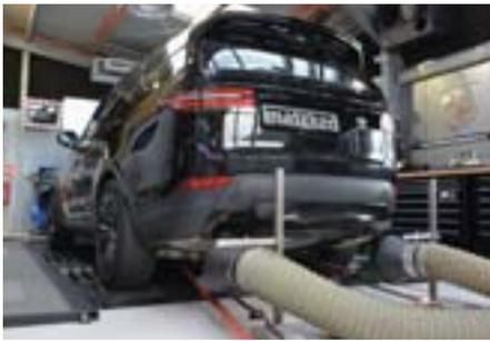
Die Leistung des Discovery 5 mit dem 180-PS-Motor wird um bis zu 31 PS und bis zu 55 Nm angehoben. Die höchste Leistungs- und Drehmomentsteigerung findet dabei im mittleren Drehzahlbereich zwischen 1.900 und 3.200 U/min statt. Dadurch ist diese Veränderung besonders effizient und deutlich spürbar, denn es handelt sich um den anteilig am meisten genutzten Drehzahlbereich. Sowohl für Überholvorgänge als auch zum Ziehen schwerer Lasten hält der Motor eine höhere Reserve bereit. Die
