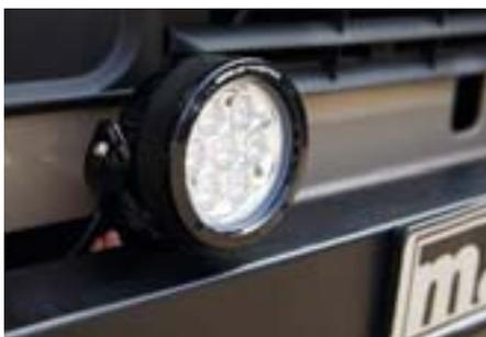
Unsere LED-Scheinwerfer mit modernster Lichttechnik haben eine enorme Leuchtkraft bei geringen Außenabmessungen, sodass Windgeräusche oder ein Beschädigungsrisiko, z. B. durch Äste im Gelände, kaum gegeben sind. Diese Fernscheinwerfer sorgen für eine extrem leistungsstarke Gelände- und Fahrbahnausleuchtung. Aufgrund der geringen Bautiefe können die LED-Scheinwerfer auf dem Frontstoßfänger des Defender montiert werden. Die LED-Lichttechnik bietet
