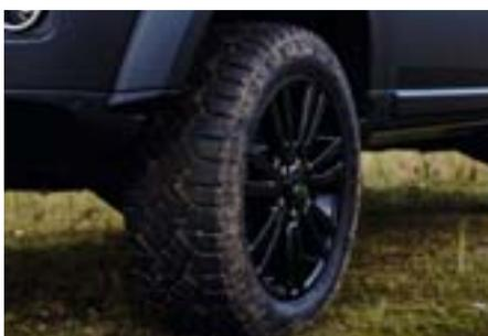
Einen sehr guten Kompromiss für die Bereifung des Discovery stellt die AT-Bereifung im 19-Zoll-Format dar. Der Reifen hat mit seiner 55%-Flanke eine gute Anpassungsfähigkeit im Gelände, fährt sich jedoch dabei nicht zu schwammig auf der Straße. Ebenso das Profil: als AT-Reifen ist der General AT oder Continental Cross Contact AT sowohl auf der Straße als auch im Gelände gut einsetzbar. Die Robustheit dieser Reifen gibt die nötige Sicherheit bei Einsätzen im felsigen Gelände. Im Sand ist
