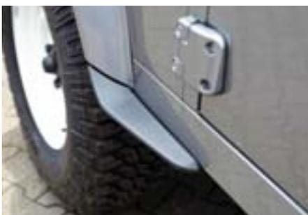
Jeder kennt das Problem: Die Seiten des Defenders verschmutzen stark, wenn durch Nässe und Schlamm gefahren wird. Besonders an den Türgriffen ist dies unangenehm. Sofern der Defender mit breiteren Reifen oder einer Spurverbreiterung ausgerüstet ist wird dieser Umstand noch verstärkt. Die Schmutzabweiser reduzieren dieses Problem erheblich. Sie verschließen den Zwischenraum zwischen der Kotflügelverbreiterung und dem Schmutzfänger, durch den der Schmutz größtenteils
