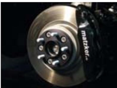
Beim Range Rover Sport TDV6 bis Modelljahr 2009 ist eine Bremsanlage mit Einkolben-Schwimmsätteln an der Vorderachse eingebaut. Mit unserer verstärkten Bremsanlage werden stattdessen Brembo-Vierkolben-Bremssätteln eingebaut. Zudem sind die Bremsscheiben mit einem Durchmesser von 360 mm um 45 mm größer. Die Bremsleistung und das Bremsgefühl verbessern sich damit enorm. Der Lieferumfang beträgt zwei Brembo-Vierkolben-Leichtmetall-Bremssättel, zwei
