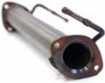
Als Ersatz für den Hauptschalldämpfer bieten wir ein Abgasrohr an. Es ist passgenau gefertigt und reduziert den Abgas-Gegendruck. Vor allem jedoch wird durch die geringere Oberfläche die Wärmeabgabe der Abgasanlage in den Innenraum reduziert. Ein positiver Nebeneffekt ist auch die Gewichtsreduzierung von bis zu 7 kg (je nach Ausführung). Das Geräuschniveau ändert sich beim Defender 2.2 mit Dieselpartikelfilter nicht, beim 2.4-Liter-Modell minimal und beim Td5-Modell ge-
