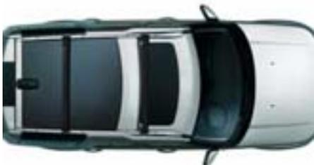
Die Dachreling ist die Voraussetzung, um Lasten auf dem Dach des Discovery zu transportieren. Es handelt sich um eine flache Aluminiumschiene, in deren Profil verschiedene Trägersysteme wie z. B. die Dachquerträger oder der Expedition-Dachgepäckträger befestigt werden können. Die Befestigungspunkte am Fahrzeug sind vorbereitet. Die Reling ist auch in einer kurzen Ausführung oder in Silber lieferbar. Es handelt sich um ein originales Land Rover-Zubehörteil. Montage 8 AW.
