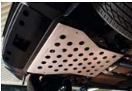
Diese Leichtmetall-Panzerung des Unterbodens schützt den Motor, die Vorderachse sowie die Getriebeeinheit zuverlässig vor Beschädigungen im Gelände. Wir haben ein sehr stabiles und trotzdem leichtes, zweiteiliges Unterfahrschutz-System aus 6-mm-Leichtmetall konstruiert. Diese wichtige Offroad-Ausrüstung ist nicht nur bei unübersichtlicher Flussdurchfahrt unerlässlich. Die Löcher im Leichtmetall sorgen zum einen dafür, dass die Kühlung nicht verschlechtert wird und zum anderen, dass
