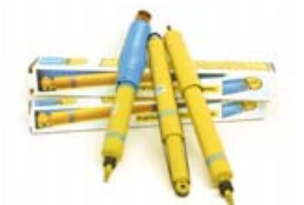
Das Handling Kit für den Discovery besteht aus vier Bilstein-Gasdruck-Stoßdämpfern. Besonders an der Vorderachse neigt der Discovery zum Durchschlagen, da er nur einen geringen Einfederweg hat und die Federung komfortorientiert abgestimmt ist. Hier hilft der Gasdruck-Dämpfer mit seiner belastbaren Druckstufe. Aber auch insgesamt ist die Dämpfungsleistung höher und der Bodenkontakt wird erhöht. Durch das ruhigere Fahrverhalten steigt auch der Komfort spürbar.
