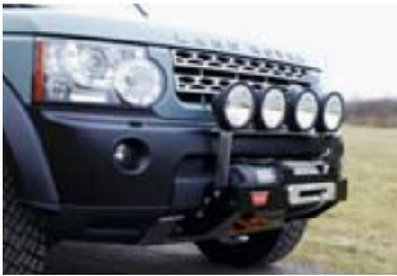
Dieser Seilwinden-Anbausatz ist ein originales Land Rover-Zubehörteil. Die WARN-Seilwinde wird vor dem Stoßfänger in eine stabil ausgeführte Seilwindenaufnahme montiert. Die Fahrzeuglänge ändert sich um 20 cm. Die Zugleistung beträgt 4.300 kg bei einer Seillänge von 38 Metern. Der Lieferumfang beträgt die Winde, den Anbausatz, die Fernbedienung mit einer Kabellänge von 3,70 Metern, das Montagezubehör, den Elektrosatz mit Hauptstromunterbrecher und eine Schutzabde-
