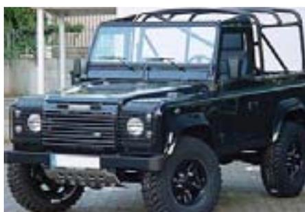
Der Sicherheitskäfig für den Defender 90 Soft Top besteht aus dem Überrollbügel (siehe dazu separate Produktbeschreibung „Überrollbügel Defender 90 Soft Top“) sowie einem Ersatz des hinteren Spriegel-Gestänges. Dieses Rohrgestell besteht aus nahtlos gezogenem Stahlrohr und ist mit stabilen Halterungen am Aufbau und dem Überrollbügel verschraubt. Das serienmäßige Planenverdeck kann weiter verwendet werden. Mit dem Sicherheitskäfig ist ein wirksamer Schutz der
