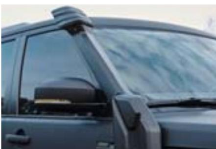
Dieses Lufteinlassrohr aus schwarzem Kunststoff ist ein Land Rover-Originalteil. Es verlängert die Standzeit des Luftfilters erheblich, da die Ansaugluft in Dachhöhe staubärmer ist. Bei Wasserdurchfahrt ist es ein absolutes Muss, da z. B. beim Durchfahren fließender Gewässer die Ansaugöffnung im Kotflügel durch den Wasserschwall bereits bei geringen Tiefen geflutet werden kann und, sofern der Motor Wasser ansaugt, ein kapitaler Schaden entsteht. Der Lieferumfang beträgt das
