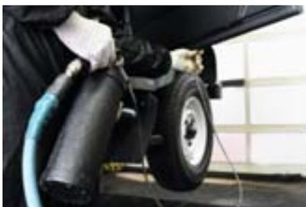
Im Rahmen der Hohlraumversiegelung werden das Fahrgestell, die Stirnwand sowie die Türen innen mit einem hochwertigen Schutzwachs ausgespritzt. Bei Erwärmung wird das Wachs flexibel, verschließt eventuell entstandene Risse und wirkt daher als langfristiger Schutz. Störender Austritt von flüssigem Wachs findet auch im Sommer nicht statt. Vor der Durchführung sollte das Fahrzeug möglichst trocken und sauber sein. Gern führen wir ei-
