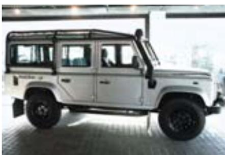
Einen besonders guten Insassen- und Fahrzeugschutz bietet der Full-External-Roll-Cage, der außenliegende Komplettkäfig. Die sechsfache Abstützung auf dem Fahrgestell im Bereich der A-, C- und D-Säulen schaffen höchste Stabilität und einen hervorragenden Insassenschutz ohne den Innenraum einzuschränken. Er ist an sechs Punkten mit dem Fahrgestell verbunden. Halterungen für Scheinwerfer und eine Gepäckablage sind vorgesehen. Ein passender Dachgepäckträger ist als
