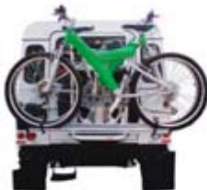
Dieser Fahrradträger ermöglicht den Transport von zwei Fahrrädern am Reserverad des Defenders. Damit ist die Montage des Trägers besonders schnell und einfach. Zudem kann der Träger für den Transport von Ski oder Snowboards umgerüstet werden. Er besteht größtenteils aus Leichtmetall und verfügt über eine Drahtseil-Spannbefestigung.
