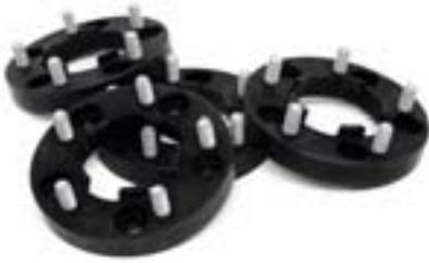
Eine Verbreiterung der Spur bewirkt eine bessere Straßenlage des Fahrzeugs. Die Rollneigung, also das Wanken des Fahrzeugs, wird reduziert. Das Fahrverhalten wird angenehmer und sicherer, bei sportlicher Fahrweise ist sogar feststellbar, dass die dynamische Stabilitätskontrolle erst später eingreifen muss. Die optische Erscheinung des Fahrzeugs wird ebenfalls verbessert. Die Spurverbreiterung beträgt 50 mm je Achse. Die Distanzscheiben bestehen aus hochfestem Leichtmetall, um
