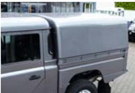
Durch die Montage dieses Hard Tops gewinnt der Defender 130 enorm an Nutzwert. Es entsteht ein großes, sicheres und geschütztes Nutzvolumen für alle Einsatzbereiche. Das in Deutschland gefertigte Hard Top besteht aus glasfaserverstärktem Kunstharz und ist somit äußerst robust und langlebig. Das formschöne Hard Top folgt der Außenkontur des Defenders und passt sich damit harmonisch dem Fahrzeug an. Es wird fest mit der Ladefläche verschraubt und verfügt über eine dicht schließende
