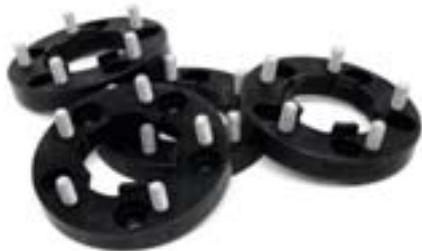
Diese Distanzscheibe ist aus Leichtmetall produziert, damit die ungefederten Massen nicht unnötig erhöht werden. Sie ist 30 mm stark. Es wird nicht nur die Fahrstabilität erhöht, sondern auch der Wendekreis verringert, da der Lenkansschlag entsprechend eingestellt werden kann. Neben der verbesserten optischen Erscheinung des Fahrzeugs ist die Spurverbreiterung eine echte Verbesserung der Fahrsicherheit, da Straßenlage und Kippsicherheit spürbar erhöht werden. Die Dis-
