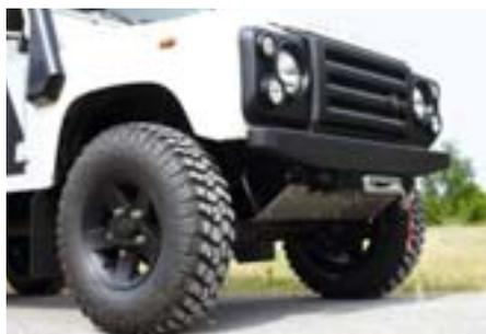
Der BF Goodrich Mud Terrain KM2 255/85R16 123Q erfüllt die aktuellen Anforderungen bezüglich der Geräuschemissionen und Fahrsicherheit und ist ein Maßstab in Sachen Geländegängigkeit. Zudem ist er als flankenverstärkter 10-PR-Reifen äußerst robust. Die verwendete LM-Felge Boost von Land Rover ist ebenfalls von höchster Qualität. Die Straßeneigenschaften sind für die hohe Geländetauglichkeit noch erstaunlich gut, stellen aber gegen-
