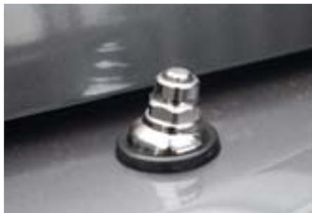
Die originale Antenne wird bei Fahrten im Wald und durch Buschwerk leicht abgeknickt. Das kann bei dieser vollautomatischen Versenk-Antenne nicht mehr passieren. Die UKW/MW-Antenne wird per Zündung aktiviert und kann dann vollautomatisch über Ihr Autoradio gesteuert werden. Bei entsprechenden Fahrten kann man die Antenne also per Knopfdruck ein- oder ausfahren. Das Teleskop besteht aus robustem Edelstahl. Montage 14 AW.
