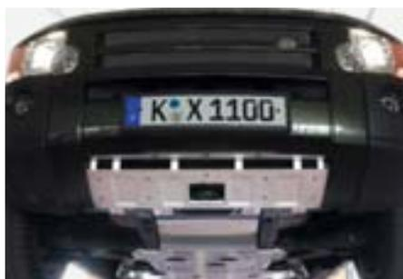
Diese Leichtmetall-Panzerung des Unterbodens schützt den Motor, die Vorderachse sowie die Getriebeeinheit zuverlässig vor Beschädigungen im Gelände. Sie ist dreiteilig und besteht aus 6 mm starkem Flugzeug-Aluminium. Diese wichtige Offroad-Ausrüstung ist nicht nur bei unübersichtlicher Flussdurchfahrt unerlässlich. Lieferbar für den Discovery 3 und 4. Bitte geben Sie uns bei einer Bestellung die Fahrgestellnummer Ihres Discoverys an. Montage 49 AW.
