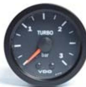
Dieses 52-mm-VDO-Rundinstrument passt sehr gut zur Defender-Instrumentierung. Es gibt den Ladedruck im Saugrohr an. Damit kann das Ladedrucksystem überwacht werden, da bei einer Leckage, z. B. wegen eines gerissenen Ladeluftschlauchs, der Systemdruck abfällt. Ebenfalls kann die Fahrweise angepasst werden, um im optimalen Ladedruckbereich zu fahren. Der Anzeigebereich beträgt 0 bis 3 Bar, das Instrument ist sehr gut ablesbar und universell montierbar. Für TDI-
