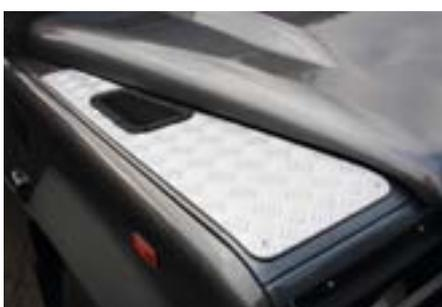
Die originalen Land Rover-Kotflügel-Schutzbleche ermöglichen es, die Kotflügel zu begehen, um z. B. den Dachgepäckträger zu beladen. Sie bestehen aus 5 mm starkem Riffelaluminium (die Oberfläche ist gebeizt). Die Bleche sind passgenau gearbeitet und folgen der Kontur des Kotflügels. Sie werden mit eingesenkten Edelstahlschrauben montiert. Eine selbstklebende Moosgummi-Unterlage verhindert das Eindringen von Feuchtigkeit unter die Bleche. Der Lieferumfang
