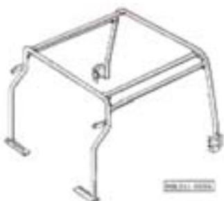
Für den Defender 110 Station bieten wir eine innenliegende Sicherheitszelle an. Sie besteht aus zwei Bügeln, die entlang der B- und C-Säule montiert werden und mit dem Fahrgestell verbunden sind. Sie sind mit vier Längsstreben miteinander verbunden und bilden einen Käfig, der die mittlere Sitzreihe umschließt. So wird der gesamte Insassenbereich wirksam geschützt. Der Bügel besteht aus nahtlos gezogenem Stahlrohr und ist schwarz pulverbeschichtet. Er kann auch durch einen au-
