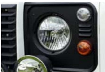
Diese originalen Land Rover-Klarglas-Scheinwerfer stammen aus dem Sondermodell SVX. Sie haben eine europäische Betriebsgenehmigung und entsprechen der StVO. Die Lichtleistung ist deutlich höher als beim serienmäßigen Scheinwerfer. Im Gegensatz zu LED-Leuchten wird damit ein homogeneres Lichtfeld erzeugt. Die Farbtemperatur ist Geschmackssache, es kann zwischen LED und Halogen gewählt werden. Die Klarglas-Scheinwerfer können bei jedem Defender, auch in Ver-
