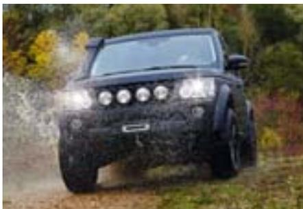
Das Handling Kit für den Discovery besteht aus einem Satz Gasdruck-Stoßdämpfer, die mit einer höheren Dämpfungsleistung von Bilstein hergestellt werden. Dadurch wird die Radführung verbessert, das Fahrzeug fährt sich präziser, ruhiger und mit weniger Vibrationen. Vor allem aber wankt die Karosserie bei Kurvenfahrt deutlich weniger. Auch die Belastbarkeit bei Fahrten im Gelände oder mit erhöhter Zuladung ist höher. Im Anhängerbetrieb liegt das gesamte Ge-
