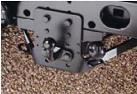
Diese originale Land Rover-Anhängerkupplung liefern wir mit sämtlichen Montageteilen sowie dem Elektrosatz. Sie verfügt über eine europäische Betriebsgenehmigung und muss deshalb nicht vom TÜV abgenommen werden. Es gibt für die drei Fahrzeugausführungen 90, 110 und 130 drei verschiedene Versionen. Bitte geben Sie uns bei der Bestellung die Fahrgestellnummer und das Baujahr Ihres Defenders an. Montage 22 AW.
