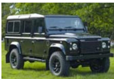
Durch die dunkle Tönung der Verglasung ab der B-Säule entsteht ein Sichtschutz für den Innenraum und die Erwärmung durch Sonneneinstrahlung wird reduziert. Wir verwenden dafür eine hochwertige Markenfolie mit allgemeiner Betriebserlaubnis. Bei dem sorgfältigen Einbau werden die Scheiben teilweise ausgebaut, sodass später kaum erkennbar ist, dass es sich um eine Folientönung handelt. Die Tönung umfasst die Verglasung der Fondtüren, die seitlichen Schiebefenster, die drei
