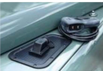
Das Gehäuse der Seilwindensteuerung wird bei der integrierten Seilwinde auf dem Frontstoßfänger montiert. Die Funktion ist damit gegeben, jedoch ist sie dort den Witterungseinflüssen ausgesetzt, wird bei einem leichten Anstoß bereits beschädigt und verschönert nicht gerade den Anblick Ihres Defenders. Deshalb bieten wir einen Elektrosatz an, um die Steuereinheit innerhalb des Motorraumes zu montieren. Dafür werden die Hochstrom-Zuleitungen verlängert und die Buchse für
