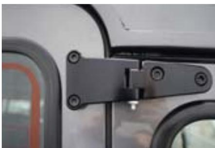
Bei der Verwendung größerer Räder werden die Hecktür und deren Scharniere überlastet. Wenn häufig im Gelände oder auf schlechteren Wegstrecken gefahren wird, setzt sich die Hecktür und das Schloss klemmt. Abhilfe schaffen unsere Hecktürscharniere aus hochfestem Flugzeug-Aluminium. Sie sind abschmierbar und mit einer Messinghülse versehen in der ein VA-Bolzen mit Wendelnut läuft. Dies sorgt für eine optimale Schmierung und verringert den Verschleiß erheblich. Die Scharniere
