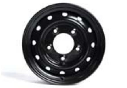
Diese Land Rover-Stahlfelge hat die Abmessung 6,5 x 16 ET 20,6. Es handelt sich um die serienmäßig auf dem Defender 130 montierte Felge. Ihr Gewicht beträgt 15,5 kg. Im dazu gelieferten Teilegutachten sind die Reifengrößen 255/85R16 sowie 235/85R16 erfasst. Die Reifendimension 265/75R16 kann mit einer TÜV-Einzelabnahme montiert werden. Durch die Einspresstiefe wird die Radmitte gegenüber der serienmäßigen Ausrüstung des Defender 90 und 110 um 12,4 mm nach au-
