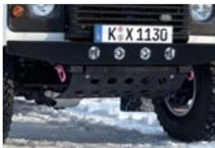
Dieser Unterfahrschutz besteht aus einer sehr stabilen und tief hinuntergezogenen Lochplatte aus Leichtmetall mit einer Materialstärke von 6 mm. Sie ist seidenmatt schwarz pulverbeschichtet. Der Unterfahrschutz ist zerlegbar, damit er im Beschädigungsfall leicht demontiert und gerichtet werden kann, falls er das Lenkgestänge behindert. Die seitlichen Halterungen bestehen aus Stahl. Die Löcher sorgen zum einen dafür, dass die Kühlung nicht verschlechtert wird und zum anderen, dass
