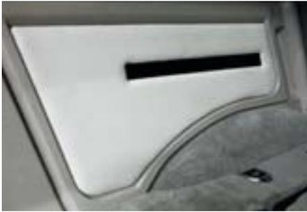
Das Luftheizgerät montieren wir hinter der linken Innenverkleidung des Laderaumes. Es nimmt dort keinen nutzbaren Raum ein und erwärmt das serienmäßig wenig beheizte Fahrzeugheck. Optisch ist die Heizung nur an einem unauffälligen Gitter für den Luftauslass sowie der Programmuhr erkennbar. Für die Montage muss eine Konsole sowie ein Halterungssatz angefertigt werden. Die Steuerung erlaubt eine Wochen-Programmierung und die Temperatur ist stufenlos regelbar. Sie wird
