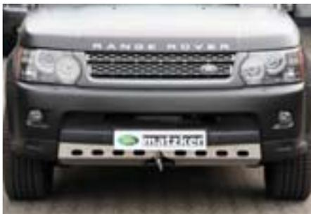
Dieser Seilwinden-Satz ist in den Stoßfänger des Range Rover Sport integriert. So wird der vordere Böschungswinkel nicht verschlechtert und die Abmessungen des Fahrzeugs werden nicht vergrößert. Das Seilfenster ist hinter dem abnehmbaren Kennzeichen eingebaut. Die WARN-Seilwinde hat eine Zugleistung von 5.400 kg und verfügt über ein 25 Meter langes Stahlseil. Die Kupplung für die Kabelfernbedienung wird unauffällig in die Frontmaske eingebaut. Eine im Motorraum montierte
