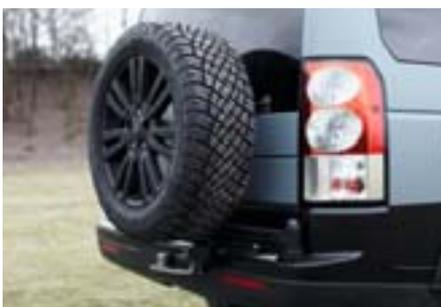
Mit diesem schwenkbaren Träger zur Montage am Fahrzeugheck des Discovery kann ein Reserverad transportiert werden. Der Reserveradhalter ist für den harten Offroad-Einsatz konzipiert und äußerst robust. Er wird mit einer Verstärkung am Fahrgestell unter dem Stoßfänger montiert. Eine Arretierung hält das Rad im geöffneten Zustand. Der verbleibende Platz am Unterboden kann für einen 100-Liter-Zusatztank genutzt werden oder es kann so ein zweites Reserverad transportiert
