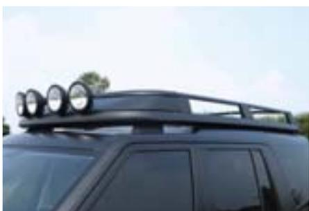
Der Expeditions-Dachgepäckträger ist äußerst robust und tragfähig. Durch die umlaufende Reling ist er sehr vielseitig einsetzbar, es können Ausrüstungsgegenstände ebenso wie Transportkisten geladen werden. Der mitgelieferte Befestigungssatz beinhaltet Ringmuttern, die an beliebigen Punkten angebracht werden können, sodass die Ladung mit Spanngurten gesichert werden kann. Der Boden des Dachträgers besteht aus profilierten Planken und ist sicher begehbar. Der gesamte Dachgepäck-
