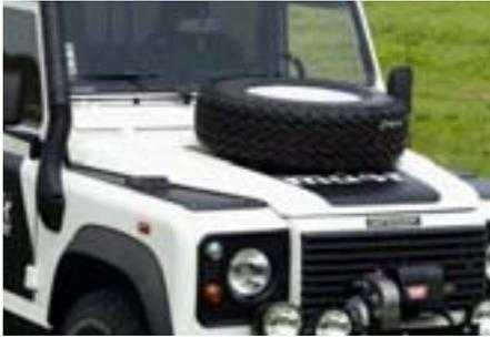
Bei allen Defendern bis Modelljahr 2006 kann das Reserverad auf der Motorhaube montiert werden. So kann ein zweites Reserverad mitgeführt werden, ohne im Innenraum Platz wegzunehmen oder die Hecktür kann vom Reserverad befreit werden. Das Reserverad auf der Motorhaube trägt zudem zum Ausgleich der Achslasten des beladenen Defenders bei. Der Satz umfasst eine stabile Leichtmetall-Verstärkung, die von unten montiert wird und eine obenliegende Trägerplatte mit Halte-
