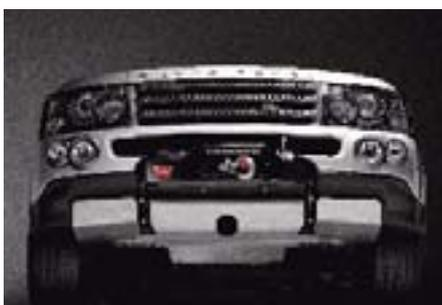
Dieser Leichtmetall-Unterfahrschutz schützt den Frontbereich des Unterbodens Ihres Range Rover Sports zuverlässig. Er ist aus 6-mm-Leichtmetall gefertigt und ersetzt die empfindlichen Kunststoffteile in diesem Bereich. Montage 14 AW.
