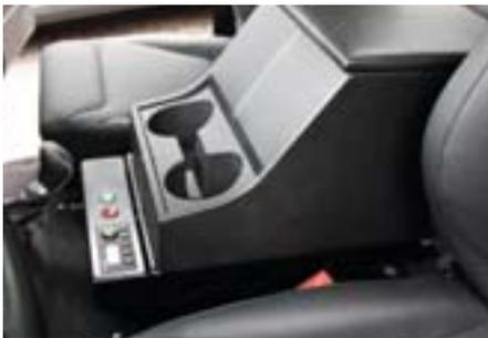
Die Luftstandheizung kann beim Defender 110 unter der Rücksitzbank montiert werden (weitere Einbaumöglichkeiten sind sehr begrenzt, wenn das Heizgerät im Innenraum nicht stören soll). Es wird mit einer Trägerplatte – die bereits zur Aufnahme der Standheizung vorbereitet ist – unter der Mittelkonsole montiert und hebt diese damit um 150 mm an. Das Heizgerät kann nun zwischen den Vordersitzen unsichtbar montiert werden und die Warmluft strömt nach hinten in den Fußraum
