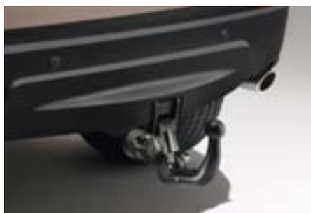
Die abnehmbare original Land Rover-Anhängerkupplung liefern wir mit sämtlichen Montageteilen sowie dem Elektrosatz. Sie verfügt über eine europäische Betriebsgenehmigung und muss deshalb nicht vom TÜV abgenommen werden. Dank einfachem und praktischem An- und Abbau sorgt diese Anhängerkupplung bei Nicht-Verwendung für einen nahtlosen Look. Maximale Zugleistung: 2.500 kg/ 2.200 kg für Sitzoption 5 + 2 (genaue Leistung abhängig von Motor, Antriebsstrang-
