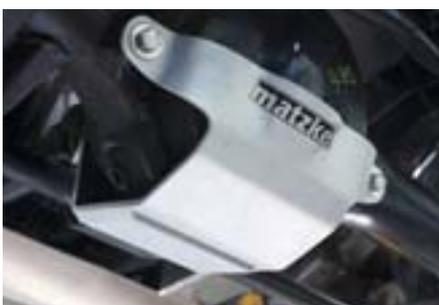
Der Leichtmetall-Differentialschutz schützt das Achsgehäuse des Defenders zuverlässig bei einem Anstoß im Gelände. Er besteht aus einer hochfesten Leichtmetall-Legierung, die in dem gefährdeten Bereich 12 mm stark ist. Zwei Haltebuchsen aus Stahl werden am Achsrohr verschweißt, sodass der Differentialschutz verschraubt werden kann und abnehmbar ist. Dieses Produkt ist lieferbar für den Defender 90 vorne und hinten sowie für den Defender 110 ab MJ 2003 hinten, hier
