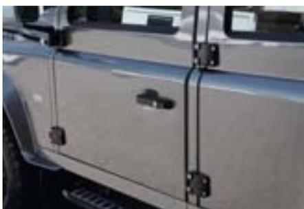
Mit der Zeit können die Türscharniere Ihres Defender ausschlagen oder rosten. Wir empfehlen Ihnen die 3-D-gefrästen Türscharniere aus hochfestem Flugzeug-Aluminium. Sie sind abschmierbar und mit einer Messinghülse versehen in der ein VA-Bolzen mit Wendelnut läuft. Dies sorgt für eine optimale Schmierung und verringert den Verschleiß erheblich. Die Scharniere sind schwarz eloxiert, zusammen mit dem Edelstahl-Montage-Satz ein optimaler Korrosionsschutz! Die Edelstahl-Schrauben
