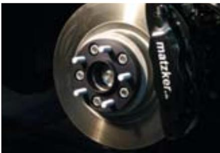
Beim Range Rover TDV8 3.6-Liter-Modell 2010 ist leider die unterdimensionierte Bremsanlage mit Einkolben-Schwimmsätteln an der Vorderachse eingebaut worden. Alternativ zu unserer Hochleistungs-Bremsanlage bietet es sich hier an, die Brembo-Vierkolben-Bremssättel zu montieren, die in den Vorjahren serienmäßig eingebaut wurden. Die Bremsleistung und das Bremsgefühl verbessern sich damit erheblich. Die Bremsscheiben müssen nicht geändert werden. Der Lieferumfang be-
