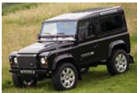
Durch die dunkle Tönung der Verglasung ab der B-Säule entsteht ein Sichtschutz für den Innenraum und die Erwärmung durch Sonneneinstrahlung wird reduziert. Wir verwenden dafür eine hochwertige Markenfolie mit allgemeiner Betriebserlaubnis. Bei dem sorgfältigen Einbau werden die Scheiben teilweise ausgebaut, sodass später kaum erkennbar ist, dass es sich um eine Folientönung handelt. Die Tönung umfasst die seitlichen Schiebefenster, die drei Heckscheiben sowie die Alpi-
