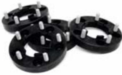
Eine Verbreiterung der Spur bewirkt eine bessere Straßenlage des Fahrzeugs. Die Rollneigung, also das Wanken des Fahrzeugs, wird reduziert. Damit wird der Bodendruck der Räder gleichmäßiger. Das Fahrverhalten wird angenehmer und sicherer, bei sportlicher Fahrweise ist sogar feststellbar, dass die dynamische Stabilitätskontrolle erst später eingreifen muss. Die Spurverbreiterung beträgt 50 mm je Achse. Die Distanzscheiben bestehen aus hochfestem Leichtmetall, um die ungefe-
