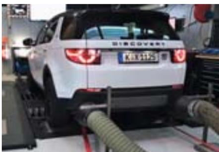
Die Leistung des Discovery Sport TD4 mit dem 150-PS-Motor wird um bis zu 31 PS und bis zu 55 Nm angehoben. Die höchste Leistungs- und Drehmomentsteigerung findet dabei im mittleren Drehzahlbereich zwischen 1.900 und 3.200 U/min statt. Dadurch ist diese Veränderung besonders effizient und deutlich spürbar, denn es handelt sich um den anteilig am meisten genutzten Drehzahlbereich. Mühelos und gleichmäßig entfaltet der Motor seine enorme Durchzugskraft. Die hohe Elastizi-
