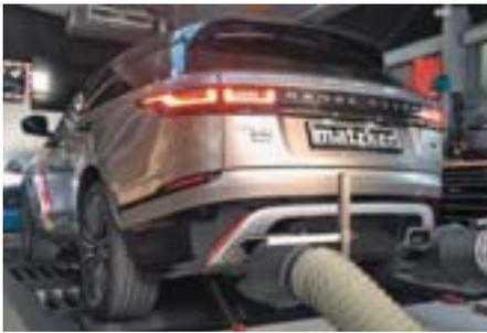
Die Leistung des Range Rover Velar mit dem 180-PS-Motor wird um bis zu 31 PS und bis zu 55 Nm angehoben. Die höchste Leistungs- und Drehmomentsteigerung findet dabei im mittleren Drehzahlbereich zwischen 1.900 und 3.200 U/min statt. Dadurch ist diese Veränderung besonders effizient und deutlich spürbar, denn es handelt sich um den anteilig am meisten genutzten Drehzahlbereich. Sowohl für Überholvorgänge als auch zum Ziehen schwerer Lasten hält der Motor eine höhere Reserve be-
