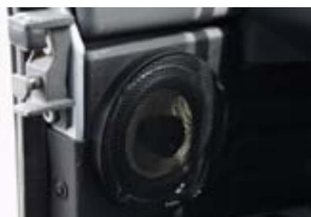
Dieses kompakte Breitband-Koaxial-Kit hat einen hervorragenden Klang. Die Basswiedergabe ist ausgesprochen gut. Als Montageort empfehlen sich die werkseitig vorhandenen Aussparungen nahe der Hecktür. Diese liegen akustisch günstig und platzsparend. Hierdurch entfallen ebenfalls nachträgliche und irreversible Veränderungen am Interieur. Besonders an diesem System sind die integrierten Hochtöner, eine integrierte Frequenzweiche sowie eine zusätzliche Sandwichmem-
