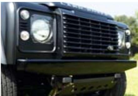
Der verstärkte Stoßfänger besteht aus einer hochfesten Aluminium-Magnesium-Legierung. Die Wandstärke beträgt 6 mm, das Profil ist im Außenbereich geschlossen, dadurch ergibt sich eine höhere Stabilität als die der serienmäßigen Stoßstange. Trotzdem bringt dieser Stoßfänger eine Gewichtsersparnis von bis zu 6,5 kg. Die Form wurde für den Geländeeinsatz optimiert, durch den hochgezogenen Außenbereich ist der mögliche Anfahrwinkel wesentlich größer. Die Leichtmetall-Stoß-
