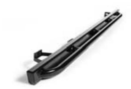
Die Schwellerblenden des Defender sind empfindlich und werden im harten Geländeeinsatz leicht beschädigt. Der Flankenschutz ersetzt diese Bleche. Er ist aus Stahl gefertigt, besonders stabil und kann sogar als Hi-Lift-Ansatzpunkt verwendet werden. Der seitliche Schutzbügel schafft einen Sicherheitsabstand bei einem seitlichen Anstoß und verhindert so einen größeren Schaden, z. B. wenn das Fahrzeug im Gelände seitlich abgleitet und an einen Baum stößt. Zudem bildet dieses
