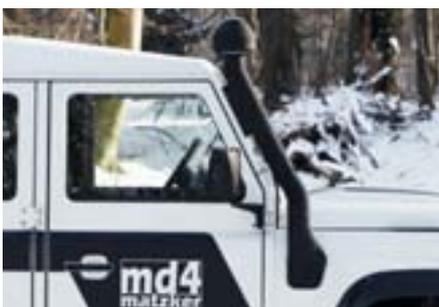
Dieser hochgesetzte Lufteinlass ist aus schwarzem Kunststoff in Land Rover-Originalform hergestellt. Eine Metallausführung ist wahlweise auch erhältlich. Im Filterkopf ist ein wartungsfreier Zentrifugalabscheider integriert. Hochgesetzte Vorfilter verlängern die Standzeit des Luftfilters erheblich, nicht nur wegen der zusätzlichen Filterung, sondern auch, weil die Ansaugluft in entsprechender Höhe staubärmer ist. Bei Fahrten in sehr staubiger Umgebung muss ohne Zusatz-Luftfilter der Filterein-
