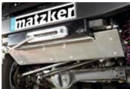
In Verbindung mit der integrierten Seilwinde lässt sich ausschließlich dieser Unterfahrschutz montieren. Er ist besonders stabil, denn er besteht aus 8 mm starkem Flugzeug-Aluminium und wird von einer Stahlkonsole getragen. Die Ausführung ist an das Windenfach angepasst. Montage 14 AW.
