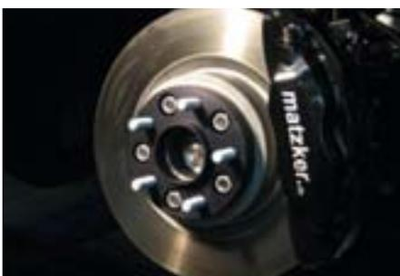
Beim Range Rover Sport ab Modelljahr 2010 ist eine Bremsanlage mit Einkolben-Schwimmsätteln an der Vorderachse eingebaut. Mit unserer verstärkten Bremsanlage werden stattdessen Brembo-Vierkolben-Bremssättel eingebaut. Die Bremsleistung und das Bremsgefühl verbessern sich damit erheblich. Die Bremsscheiben müssen nicht geändert werden. Der Lieferumfang beträgt zwei Brembo-Vierkolben-Leichtmetall-Bremssättel, den Bremsbelagsatz sowie einen Verschleißanzeiger.
