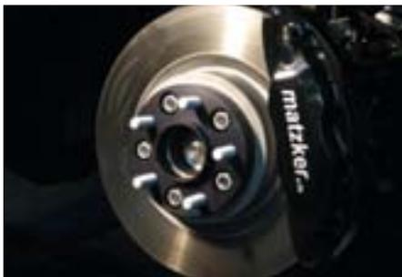
Mit diesem Produkt bauen Sie Sicherheit in Ihren Discovery ein: Beim Discovery 3.0 SDV6 ab Modell 2010 ist eine Bremsanlage mit Einkolben-Schwimmsätteln an der Vorderachse eingebaut. Aufgrund seiner guten Motorleistung kann diese leicht überlastet werden. Unsere verstärkte Bremsanlage mit Brembo-Vierkolben-Leichtmetall-Bremssätteln schafft Abhilfe. Die Bremsleistung und das Bremsgefühl verbessern sich damit erheblich. Die Bremscheiben müssen nicht geändert
