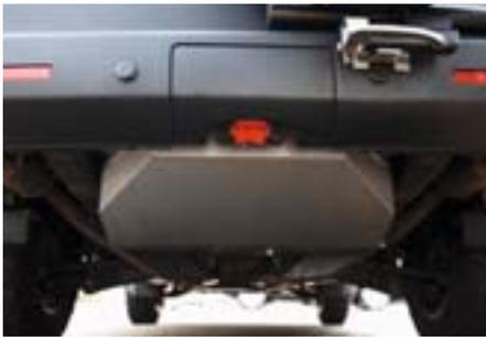
Mit diesem Zusatztank kann man mit dem Discovery über 1.800 km zurücklegen, ohne tanken zu müssen! Der 100-Liter-Kraftstofftank ist aus 2 mm starkem Tiefzieh-Stahlblech produziert und wird anstelle des Reserverades eingebaut. Dieses kann mit unserem TÜV-geprüften Reserveradhalter am Fahrzeugheck montiert werden. Er ist so robust, das auch ein Aufsetzen im Gelände keine Schäden verursacht. Das System ist sehr bedienungsfreundlich, die Befüllung findet über den serienmäßigen Einfüllstut-
