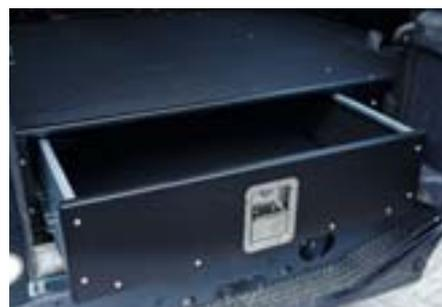
Das Schubladensystem wird auf der Ladefläche des Defenders fest eingebaut. Der Vollauszug wird bei geöffneter Hecktür nach hinten herausgezogen, das Schubladensystem ermöglicht damit eine optimale Zugänglichkeit des Stauvolumens und ist besonders empfehlenswert, wenn Sie bestimmte Gegenstände regelmäßig und häufig benötigen. Montage 18 AW.
