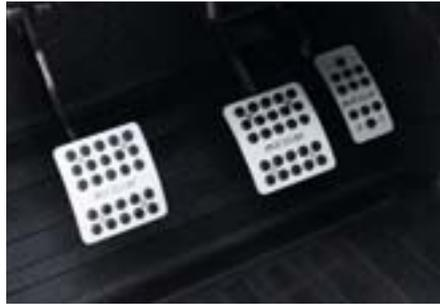
Der Gummi-Pedalbelag im Defender verschleißt wegen der hohen Bedienungskraft regelmäßig. Dieser Leichtmetall-Pedalbelagsatz ist langlebig und rutschsicher, da er mit einem Gummiprofil durchsetzt ist. Die sportliche Optik ist ansprechend und wertet den Innenraum des Defenders auf. Montage 11 AW.
