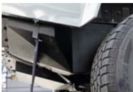
Dieser 44-Liter-Zusatztank wird zwischen dem Einfüllstutzen und dem serienmäßigen Kraftstofftank als Durchlauf tank installiert. Es ergibt sich so ein Gesamtvolumen von 119 Litern. Der Vorteil besteht in der optimalen Bedienungsfreundlichkeit, da beide Tanks durch einen Einfüllstutzen befüllt werden und keine Pumpen oder Umschalhähne erforderlich sind. Der Tank ist aus Edelstahl hergestellt und wird mit einem TÜV-Teilgutachten geliefert. Er ist lieferbar für den Defender 110 TD4 (Aus-
