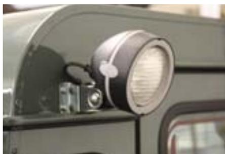
Dieser hochwertige 55-Watt-Halogen-Arbeitsscheinwerfer von Hella hat ein robustes Kunststoffgehäuse und ist allseitig schwenkbar. Er ist lichtstark und hat einen 110-mm-Reflektor. Als Arbeitsscheinwerfer hat er eine Streuscheibe mit Breitenwirkung, die jedoch das Gelände auch in einigen Metern Entfernung hervorragend ausleuchtet und ist optimal zur Montage am Heck des Defender geeignet. Er überragt die Oberkante des Dachs nicht. Der Lieferumfang umfasst den Scheinwerfer,
