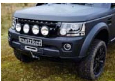
Leistungsstarke Fernscheinwerfer erhöhen die Fahrsicherheit besonders bei Nachtfahrten auf Landstraßen erheblich. Der Luminator 170 von Hella zählt zu den hochwertigsten Produkten seiner Art. Er hat einen Durchmesser von 170 mm sowie eine Bautiefe von 50 mm ab der Befestigung und kann damit auf der Stoßstange des Discovery montiert werden. Das Gehäuse besteht aus Metall-Druckguss und ist professionell abgedichtet. Der Freiflächenreflektor sowie die Klarglastechnik sorgen
