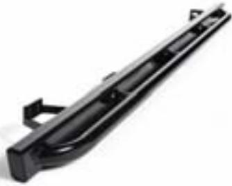
Die Schwellerblenden des Defenders sind empfindlich und werden im harten Geländeeinsatz leicht beschädigt. Der Flankenschutz ersetzt diese Bleche. Er ist aus Stahl gefertigt, besonders stabil und kann sogar als Hi-Lift-Ansatzpunkt verwendet werden. Der seitliche Schutzbügel schafft einen Sicherheitsabstand bei einem seitlichen Anstoß und verhindert so einen größeren Schaden, z. B. wenn das Fahrzeug im Gelände seitlich abgleitet und an einen Baum stößt. Zudem bildet dieses
