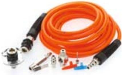
Durch die Montage eines Druckluftabganges am ARB-Kompressor kann ein Schlauch zur Reifenbefüllung angeschlossen werden. Der Lieferumfang beträgt den erforderlichen Anschluss sowie den Füllschlauch. Montage 5 AW.
