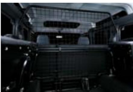
Das Metallgitter zur sicheren Abtrennung des Laderaums verhindert, dass bei einer Vollbremsung Objekte aus dem Laderaum in die Fahrgastzelle gelangen können. Es ist ohne Werkzeug leicht herauszunehmen und der untere Teil kann separat verwendet werden. Eine klappbare Durchlade-Öffnung ermöglicht auch mit der Abtrennung den Transport langer Gegenstände. Montage 11 AW.
