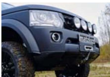
Dieser Seilwinden-Satz ist in den Stoßfänger des Discovery integriert. Das Seilfenster ist hinter dem abnehmbaren Kennzeichen eingebaut. Insofern wird die hervorragende Alltagstauglichkeit des Discovery nicht beeinträchtigt. Die Warn-Seilwinde hat eine Zugleistung von 3.600 kg und verfügt über ein 30-Meter-Stahlseil. Die Kupplung für die Kabelfernbedienung wird unauffällig in die Frontmaske eingebaut. Eine im Motorraum montierte Hauptstromunterbrechung schützt vor un-
