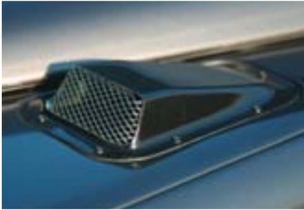
Diese Lufthutze erhöht den Luftdurchsatz im Lüftungssystem, sobald Sie schneller als 40 km/h fahren. Dadurch wird die Heiz- und Kühlleistung erhöht und die Luftqualität im Innenraum durch mehr Frischluft verbessert. Dieses, sich auf der Beifahrerseite befindliche, Air Duct verbessert das Innenraum-Klima wie oben beschrieben. Montage 2 AW.
