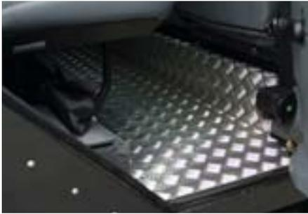
Für Fahrzeuge, deren Innenraum stark beansprucht wird, bieten wir eine Auskleidung des Fußraumes aus Leichtmetall-Riffelblech an. Das Blech ist passgenau geschnitten und kleidet exakt den Fußraum im Fond aus. Nach unten erfolgt die Abdichtung durch Moosgummi. Die Materialstärke beträgt 5 mm inkl. Riffel. Pflegeleichter geht es nicht! Bitte geben Sie uns bei einer Bestellung das Modell an. Der Lieferumfang beträgt eine Riffelalumi-
