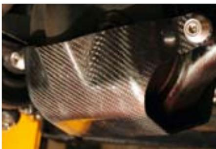
Ein Differentialschutz ist immer dann unerlässlich, wenn schwer einsehbares Terrain befahren wird, z. B. im hohen Gras oder beim Durchfahren von Gewässern. Ein Anstoß an einem Stein mit der Vorderseite des Achsrohres kann zu Deformationen oder Undichtigkeiten führen, die einen Differentialschaden nach sich ziehen. Bei dem Carbon-Differentialschutz handelt es sich um ein Motorsport-Bauteil, dessen Einsatz auch beim Alltagsfahrzeug zweckmäßig ist. Die ungefederten Massen, also
