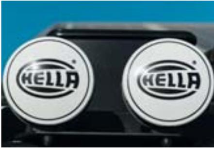
Die meisten Zusatzscheinwerfer verfügen über ein Druckguss-Gehäuse, das vor Spritzwasser und Staub schützt. Das Gehäuse erhöht die Lebensdauer der Scheinwerfer. Da die Beleuchtungseinheiten bei Geländefahrten äußerlich dennoch rasch verschmutzen und hiernach keine ausreichende Leuchtkraft mehr abzurufen ist, bieten wir für jegliche Scheinwerfer aus unserem Portfolio, zusätzlich robuste Schutzabdeckungen, welche vor Schmutz und Steinschlägen schützen. Bitte
