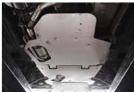
Diese Leichtmetall-Panzerung des Unterbodens schützt den Motor, die Vorderachse sowie die Getriebeeinheit zuverlässig vor Beschädigungen im Gelände. Sie ist dreiteilig und besteht aus 6 mm starkem Flugzeug-Aluminium. Das Schutzsystem wurde zusätzlich mit Öffnungen zwecks thermischer Belüftung und für einen raschen Ölservice versehen. Diese wichtige Offroad-Ausrüstung ist nicht nur bei unübersichtlichen Flussdurchfahrten unerlässlich. Bitte geben Sie uns bei einer Be-
