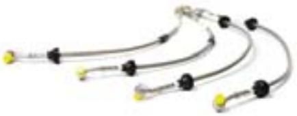
Diese Teflon-Bremsleitungen mit Edelstahl-Ummantelung sind extrem robust. Deshalb empfehlen wir sie für Fahrzeuge, die besonderen Belastungen ausgesetzt sind wie z. B. im harten Offroad-Einsatz oder auf Fernreisen. Zudem sind sie druckstabiler und verbessern so das Bremsgefühl. Land Rover empfiehlt, die serienmäßigen Bremsschläuche nach vier Jahren oder einer Laufleistung von 80 Tkm zu erneuern, dies ist eine gute Gelegenheit, die Stahlflex-Leitungen zu mon-
