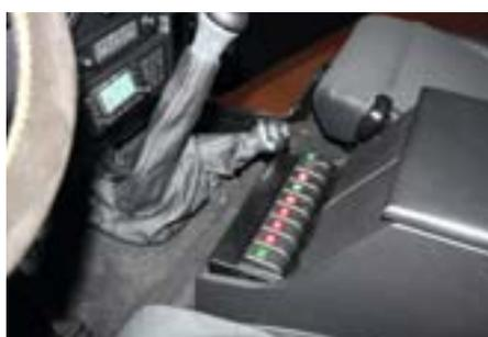
Zum Einbau in die Ablagebox bieten wir anstelle des Getränkehalters eine Edelstahlkonsole mit neun hochwertigen Schaltern von Hella an. Es ist eine Vielzahl von elektrischen Schaltfunktionen und Schaltersymbolen lieferbar. Zudem gibt es die Schalter als Taster, mit Betätigungssperre sowie mit Auffind- und Funktionsbeleuchtung. Es können also sämtliche Zusatzfunktionen bedient werden. Montage nach Aufwand.
