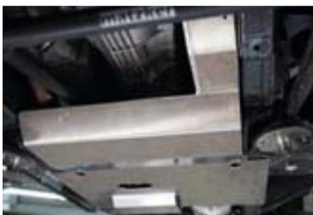
Die Getriebeschutzplatte schützt das Schalt- und Verteilergetriebe des Defenders vor einer Beschädigung bei Bodenkontakt. Sie besteht aus Flugzeug-Aluminium und ist passgenau gefertigt. Empfehlenswert ist sie bei schweren Offroad-Extremeinsätzen, z. B. in felsigem Gelände. Die Befestigungen werden am Fahrgestell angeschweißt. Montage 27 AW.
