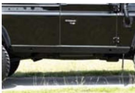
Die Schwellerblenden des Defender 110 sind empfindlich und werden im harten Geländeeinsatz leicht beschädigt. Der Seitenschweller aus Stahl ist besonders robust und kann sogar als Hi-Lift-Ansatzpunkt verwendet werden. Zudem bildet dieses Bauteil einen wirksamen Seitenaufprallschutz. Das Gewicht beträgt 28 kg. Montage 29 AW.
