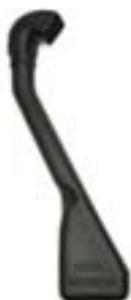
Hochgesetzter Luftansaugstutzen aus schwarzem Kunststoff. Der hochgesetzte Stutzen verlängert die Standzeit des Original-Luftfilters, da die Ansaugluft in entsprechender Höhe staubärmer ist. Über einen Zyklon-Filter verfügt dieses Lufteinlassrohr nicht. Bei Wasserdurchfahrt ist der hochgesetzte Ansaugstutzen ein Muss, da z. B. beim Durchfahren von fließenden Gewässern die Ansaugöffnung im Kotflügel durch den Wasserschwall bereits bei geringen Tiefen geflutet werden kann. Zur
