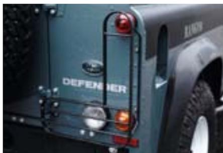
Das robuste Metall-Lampenschutzgitter schützt die Heckleuchten vor Berührungsschäden. Zur Reinigung der Leuchten kann der Lampenschutz abgeklappt werden. Für Pick-up-Modelle ist eine gesonderte Ausführung lieferbar. Montage 11 AW.
