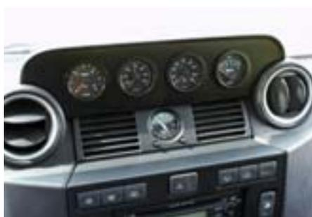
Der Defender TD4 hat eine formschöne und moderne Armaturentafel. Ein rechtwinkliges Blechgehäuse zur Aufnahme von weiteren Schaltern, Instrumenten oder einer Navigation wie für die älteren Modelle passt dazu nicht mehr. Wir bieten ein Kunststoffgehäuse an, das perfekt in die Armaturentafel integriert ist. Es handelt sich um ein hochstabiles, einteiliges Formteil und befindet sich mittig zwischen den zwei Luftausströmern. Bis zu vier 52-mm-Rundinstrumente, eine Navigation
