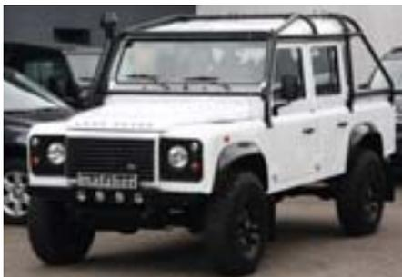
Der außenliegende Sicherheitskäfig für den Defender 110 und 130 Crew Cab ist eine optimale Voraussetzung zum Aufbau eines leistungsfähigen Arbeits- und Expeditionsfahrzeugs. Er umschließt die gesamte Kabine außenliegend. Damit verkleinert er den Innenraum nicht. Er bietet einen hervorragenden Insassen- und Karosserieschutz und umschließt den vorderen Bereich der Ladefläche ebenfalls außenliegend. Der Käfig ist an sechs Punkten fest mit dem Fahrgestell verbunden.
