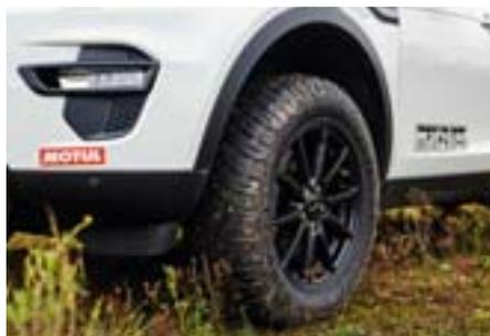
Einen sehr guten Kompromiss für die Bereifung des Discovery Sport stellt die AT-Bereifung im 17-Zoll-Format dar. Der Reifen hat mit seinem 65er Querschnitt eine gute Anpassungsfähigkeit im Gelände, fährt sich jedoch dabei nicht zu schwammig auf der Straße. Ebenso das Profil: als AT-Reifen ist der General AT oder Continental Cross Contact AT sowohl auf der Straße als auch im Gelände gut einsetzbar. Die Robustheit dieser Reifen gibt die nötige Sicherheit bei Einsätzen im felsigen Ge-
