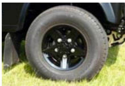
Die LR-Leichtmetall-Felge hat die Abmessung 7x16ET33. Die Traglast beträgt 1.000 kg, das Gewicht 12 kg. Im Teilegutachten ist die Reifengrößen 265/75R16 erfasst. Die Reifendimension 255/85R16 kann mit einer TÜV-Einzelabnahme montiert werden. Der Aufpreis für die Ausführung in Schwarz (seidenmatt) beträgt 130,00 Euro. Die Lieferung erfolgt inkl. der Nabenkappe.
