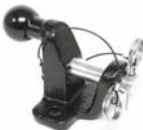
Diese robuste Schleppöse mit herausnehmbarem Bolzen und einem Kugelkopf von 50 mm ist auch als Rangierkupplung für Ringösen-Anhänger geeignet. Sie hat eine europäische Betriebsgenehmigung und muss deshalb nicht vom TÜV abgenommen werden. Die Stützlast beträgt 150 kg. Montage 3 AW.
