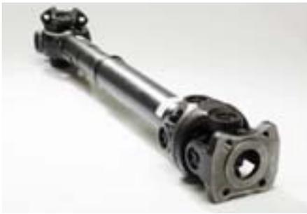
Im Falle einer Fahrwerks-Höherlegung kann es zu Drehschwingungen im Antriebsstrang des Defender kommen. Im Teillastbereich, bei einer Fahrgeschwindigkeit von mehr als 80 km/h, können diese im Verteilergetriebe ein Rasselgeräusch erzeugen. Die Weitwinkel-Doppelgelenk-Kardanwelle reduziert diese Drehschwingungen und damit die Geräusentwicklung. Montage 12 AW.
