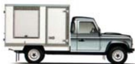
Der Defender 130 hat eine sehr große Differenz zwischen Leergewicht und zulässigem Gesamtgewicht von bis zu 1.200 kg. Die serienmäßige Federung ist für ein gutes Fahrverhalten mit einer Zuladung von bis zu 700 kg ausgelegt. Bei einer höheren Zuladung wird das Fahrverhalten schwammig und die Hinterachsfederung sinkt ein. Um dem entgegenzuwirken haben wir eine gegenläufig gewickelte Hochlast-Feder entwickelt, die ein einwandfreies Fahrverhalten bis zum maximalen Gesamtgewicht
