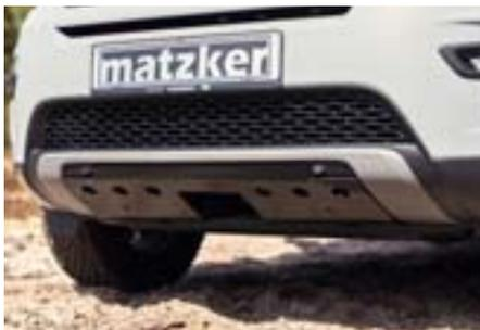
Wie diverse Tests gezeigt haben, ist der Discovery Sport äußerst geländegängig. Allerdings benötigt man einen soliden Schutz für die Fahrzeugfront, denn manchmal ist es unerlässlich, Geländepassagen mit Schwung zu durchfahren. Zudem verringert sich bei Fahrzeugen mit Einzelradaufhängung beim Einfedern die Bodenfreiheit, was schnell zu einem Bodenkontakt führen kann. Wir haben einen sehr stabilen und trotzdem leichten Front-Unterfahrschutz aus 6-mm-Leichtmetall konstruiert.
