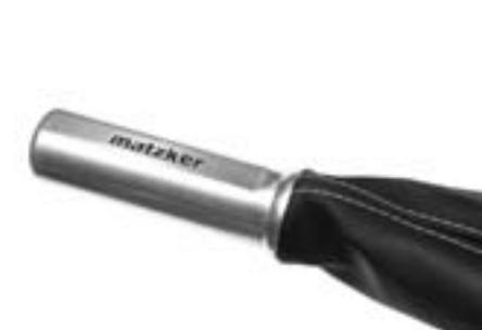
Dieser hochwertige Aluminium-Handbremshebel ersetzt den serienmäßigen Kunststoff-Handgriff im Defender. Die Oberfläche ist matt gebürstet und eine Leder-Manschette mit silberner Naht deckt den Gummi-Faltenbalg ab. Montage 4 AW.
