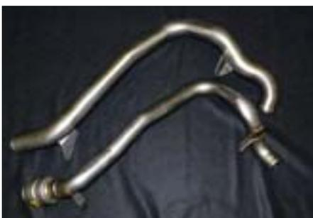
Dieses speziell geformte Ladeluftrohr mit einem vergrößerten Querschnitt reduziert den Druckabfall im Ladeluftsystem und lässt ein höheres Ladeluftvolumen zu. Mit dem Einbau wird eine Verbesserung des Ansprechverhaltens und des Füllgrades erreicht. Das serienmäßige Rohr verläuft unter dem Motor und hat einen sehr geringen Querschnitt. Montage 16 AW.
