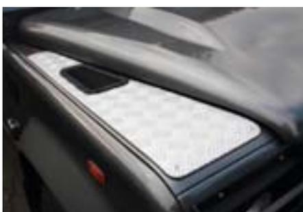
Die originalen Land Rover-Kotflügel-Schutzbleche ermöglichen es, die Kotflügel zu begehen, um z. B. den Dachgepäckträger zu beladen. Sie bestehen aus 5 mm starkem Riffelaluminium (die Oberfläche der silbernen Ausführung ist gebeizt, die der schwarzen Ausführung ist eloxiert). Die Bleche sind passgenau gearbeitet und folgen der Kontur des Kotflügels. Sie werden mit eingesenkten Edelstahlschrauben montiert. Eine selbstklebende Moosgummi-Unterlage verhindert
