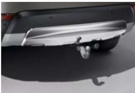
Die originale abnehmbare Land Rover-Anhängerkupplung liefern wir mit sämtlichen Montageteilen sowie dem Elektrosatz. Sie verfügt über eine europäische Betriebsgenehmigung und muss deshalb nicht vom TÜV abgenommen werden. Dank einfachem und praktischem An- und Abbau sorgt diese Anhängerkupplung bei Nicht-Verwendung für einen nahtlosen Look. Bitte geben Sie uns bei der Bestellung die Fahrgestellnummer Ihres Discoverys an. Der genannte Preis bezieht sich
