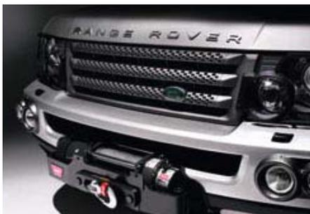
Dieser Seilwinden-Anbausatz beinhaltet eine WARN-Seilwinde mit einer Zugkraft von 4,3 t und einem 38 Meter langen Stahlseil. Sie wird in einem robusten Stahl-Vorbaugehäuse untergebracht und über eine Kabelfernbedienung gesteuert. Das PDC-System vorne kann nicht mehr genutzt werden. Montage 95 AW.
