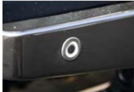
Dieses PDC-System mit jeweils vier Ultraschall-Sensoren an Front und Heck erleichtert das Einparken des Defender ungenügend. Das Frontsystem wird über das Geschwindigkeitssignal aus dem Datenbus aktiviert, die Überwachung des Fahrzeughecks über das Einlegen des Rückwärtsganges. Es handelt sich um ein drahtloses System. Die Betriebssicherheit ist sehr hoch. Montage 62 AW.
