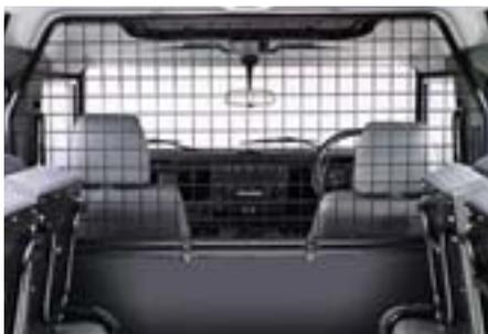
Das Metallgitter zur sicheren Abtrennung des Laderaums vom Personenbereich verhindert, dass bei einer Vollbremsung Objekte aus dem Laderaum in die Fahrgastzelle gelangen können. Es ist ohne Werkzeug leicht herauszunehmen und der untere Teil kann separat verwendet werden. Montage 11 AW.
