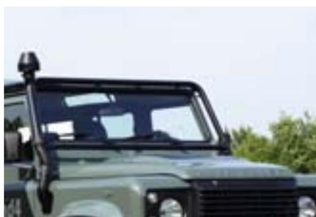
Der hochgesetzte Lufteinlass ist aus schwarz beschichtetem Stahlblech in LR-Originalform hergestellt. Er hat einen speziell geformten Anschluss-Stutzen für das Kotflügelblech, um mit der Montage eines Sicherheitskäfigs zu harmonisieren. Die Befestigung der vertikalen Luftführung erfolgt am Bügelrohr. Im Filterkopf ist ein wartungsfreier Zentrifugalabscheider integriert. Hochgesetzte Vorfilter verlängern die Standzeit des Luftfilters erheblich, nicht nur wegen der zusätzlichen Filterung,
