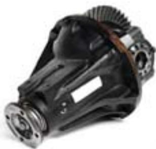
Das serienmäßig im Defender 90 vorne und hinten sowie im Defender 110 vorne verbaute Differential ist mit nur zwei Trabantenrädern zur Kraftübertragung bestückt. Zudem ist der Differentialkorb offen. Dadurch kann es bei extremer Belastung zu Brüchen kommen und bei lang andauernder Differenzdrehzahl, z. B. bei durchdrehenden Rädern im Schlamm, kommt es zu Schäden der Lagerung der Radsätze. Das Hochleistungs-Differential hat ein geschlossenes und verschraubtes
