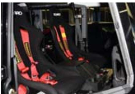
Sofern Sie besonders sicher in Ihrem De-fender sitzen möchten oder Ihr Fahrzeug im Motorsport einsetzen, können wir den professionellen Motorsport-Schalensitz Pole Position von Recaro einbauen. Mit einer eigens dafür gefertigten Konsole wird der Sitz entsprechend den FIA-Sicherheitsvor-schriften montiert. Sofern ein Sicherheits-bügel oder -käfig eingebaut ist, können auch Vier- oder Sechspunktgurte in Verbin-dung mit dem Schalensitz eingebaut wer-den. Der Sitzbezug besteht aus feuerhem-
