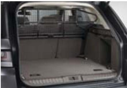
Die Laderaumabtrennung ermöglicht einen sicheren Transport von Ladungsgegenständen im Fahrzeugheck. Sie ist aus einem Stahlgitter gefertigt und sehr stabil. So wird auch bei einer Notbremsung verhindert, dass Ladungsgegenstände zu den Passagieren geschleudert werden. Es können damit auch Gepäckstücke bis unter das Fahrzeugdach geladen werden. Die Laderaumabtrennung eignet sich auch zum Transport von Hunden im Fahrzeug. Sie ist bei Bedarf schnell und ohne
