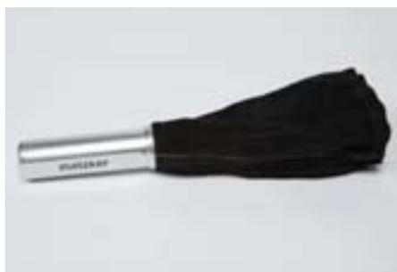
Dieser hochwertige Aluminium-Handbremshebel ersetzt den serienmäßigen Kunststoff-Handgriff im Defender. Die Oberfläche ist matt gebürstet und eine Wildleder-Manschette mit gelber Naht deckt den Gummi-Faltenbalg ab. Montage 4 AW.
