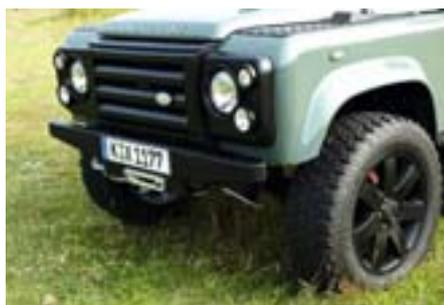
Der verstärkte Stoßfänger besteht aus einer hochfesten Aluminium-Magnesium-Legierung. Die Wandstärke beträgt 6 mm, das Profil ist im Außenbereich geschlossen. Trotzdem bringt dieser Stoßfänger eine Gewichtsersparnis von bis zu 6,5 kg. Die Form wurde für den Geländeeinsatz optimiert, durch den hochgezogenen Außenbereich ist der mögliche Anfahrwinkel wesentlich größer. Die Breite ist 85 mm geringer, was ein engeres Rangieren, besonders bei der Rückwärtsfahrt, erlaubt. Der Stoß-
