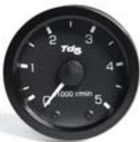
Dieser Drehzahlmesser ist ein originales Land Rover-Zubehöerteil und kann anstatt der Zeituhr neben dem Tachometer in die Instrumententafel eingebaut werden. Der Anzeigebereich ist auf den Td5-Motor abgestimmt. Die Zeituhr kann an anderer Stelle montiert werden. Der Anschluss erfolgt am Motorsteuergerät, es muss eine Leitung gelegt werden. Montage 18 AW.
