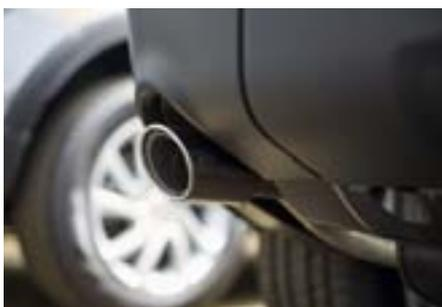
Die Performance-Abgasanlage für den Discovery Sport Diesel sorgt für einen möglichst geringen Abgas-Gegendruck. Sie ist akustisch abgestimmt und mit dem Einbau entsteht ein angenehm tiefes, jedoch nicht aufdringliches Abgasgeräusch. Die zweiflutige Anlage besteht aus 65-mm-Edelstahlrohr. Montage 18 AW.
