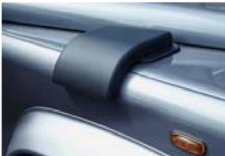
Bei starkem Schneefall wird der waagrecht auf dem rechten Kotflügel des Defenders befindliche Lufteinlass für das Heizungssystem durch eine Schneedecke verschlossen. Die Wirkung der Standheizung wird dadurch erheblich reduziert, da es an Luftdurchsatz fehlt. Die Schutzabdeckung schafft Abhilfe, denn die Luftansaugung wird seitlich am Kotflügel von unten vorgenommen und kann deshalb nicht verschlossen werden. Das Bauteil besteht aus bruchsicherem schwarzen Kunststoff
