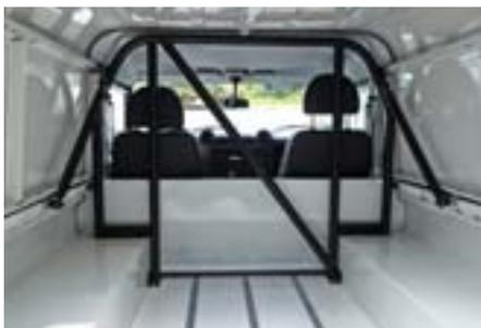
Für den Defender 90 Station/110 Hard Top bieten wir den Sicherheitsbügel nach Militärstandard an. Er besteht aus dem Hauptbügel, der hinter den Sitzen montiert und in den vorderen Ecken der Ladefläche mit soliden Verstärkungen befestigt wird. An zwei Punkten wird er mit dem Fahrgestell verbunden. Zwei Stützstreben verlaufen in einem Winkel von 45 Grad zur Stahl-Abschlussleiste der hinteren Karosserie. Der Bügel besteht aus nahtlos gezogenem Stahlrohr und ist schwarz pulver-
