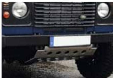
Dieser Unterfahrschutz besteht aus einer sehr stabilen und tief hinuntergezogenen Lochplatte aus Leichtmetall mit einer Materialstärke von 6 mm. Er ist zerlegbar, damit er im Beschädigungsfall leicht demontiert und gerichtet werden kann, falls er das Lenkgestänge behindert. Die seitlichen Halterungen bestehen aus Stahl. Die Löcher sorgen zum einen dafür, dass die Kühlung nicht verschlechtert wird und zum anderen, dass sich kein Schmutz auf der Schutzplatte sammelt. Dieses wichti-
