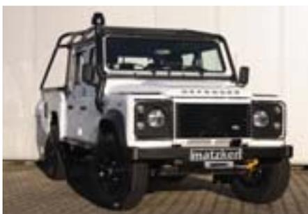
Mit diesem Federsatz wird der Defender 130 um 40 mm hochgelegt. Ansonsten hat er die gleichen Konstruktionsmerkmale und hervorragenden Fahreigenschaften wie das Standard-Suspension Kit. Neben dem optischen Effekt werden die Böschungswinkel und die Bauchfreiheit verbessert. Es sollten unbedingt längere Stoßdämpfer montiert werden, wir empfehlen unser Handling Kit oder unser Competition Kit. Durch die Höherlegung kann es im Teillastbereich zu technisch un-
