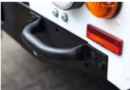
Dieser leichte Schutzbügel verhindert Schäden an den Heckleuchten bei einem leichten Anstoß hinten. Vor allem jedoch ist er ein stiles Land Rover-Accessoire, denn bereits die Serie-III-Fahrzeuge hatten diesen Aluminium-Bügel am Rahmenendträger. Der Lieferumfang beträgt einen Schutzbügel. Montage 3 AW.
