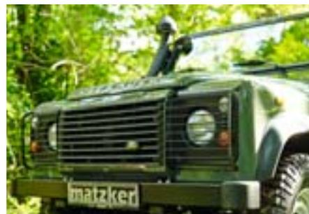
Die Lampenschutzgitter aus schwarz beschichtetem Metall sind sehr robust. Sie bewahren die Frontleuchten zuverlässig vor Beschädigungen durch einen leichten Anstoß oder einer Berührung mit Ästen und Buschwerk und sind zur Reinigung der Scheinwerfer abklappbar. Montage 11 AW.
