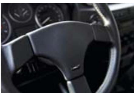
Diese Zentralabdeckung dient als Prallschutz und kann auf den 360-mm-Sportlenkrädern montiert werden. Sie ist mit schwarzem Glattleder bezogen.
