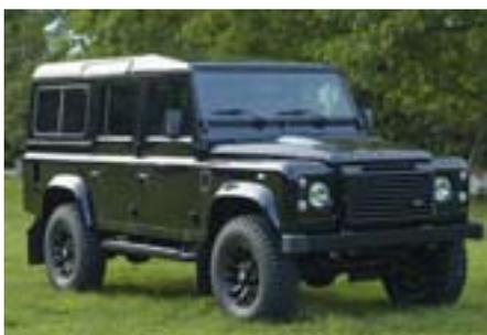
Mit diesem Federsatz wird der Defender um 50 mm hochgelegt. Ansonsten hat er die gleichen Konstruktionsmerkmale und hervorragenden Fahreigenschaften wie das Standard-Suspension Kit. Neben dem optischen Effekt werden die Böschungswinkel und die Bauchfreiheit verbessert. Die Freigängigkeit im Radhaus erlaubt die Montage größerer Reifen. Die negative Auswirkung des höheren Schwerpunktes ist durch eine ausgewogene Abstimmung der Federrate kaum spürbar. Es sollten unbedingt
