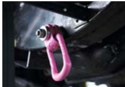
Die stabilen Zugösen sind dreh- und schwenkbar, sodass auch in einem spitzen Winkel zum Fahrzeug gezogen werden kann. Der bewegliche Teil ist federbelastet, sodass er im unbenutzten Zustand keine Klappergeräusche erzeugt. Der Lieferumfang umfasst zwei Zugösen, Adapter zur Montage am Defender-Fahrgestell sowie die Bolzen und Muttern. Montage 6 AW.
