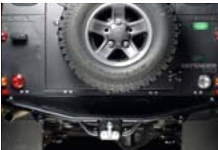
Das Heck des Defenders ist weitgehend ungeschützt. Den Abschluss bildet die hintere Quertraverse des Fahrgestells. Bei einem Anstoß im Bereich außerhalb der Längsträger knickt sie leicht ein. Die Rahmenendträgerverstärkung stützt sich im mittleren Teil des Fahrgestells zur Kräfteverteilung ab und schützt so den sensiblen Außenbereich. Zudem dient sie als Heckstoßstange und wegen dem Noppen-Gummibelag als rutschsichere Trittstufe für die Hecktür. Die mitgelieferte Anhängerkupplung ist herun-
