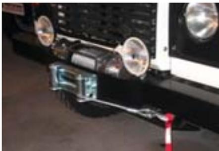
Zusatz-Fernscheinwerfer verbessern die Fahrbahnausleuchtung erheblich und erhöhen so die Fahrsicherheit. Die 55-Watt-Halogen-Scheinwerfer mit einem Durchmesser von 160 mm sind sehr lichtstark und können auf dem Stoßfänger montiert werden. Im Lieferumfang sind die Scheinwerfer, die Leuchtmittel sowie das Elektromaterial inkl. Relais enthalten. Montage 24 AW. Wir empfehlen die Kombination mit unserer Hochleistungs-Lichtanlage, da damit auch das Abblendlicht verstärkt
