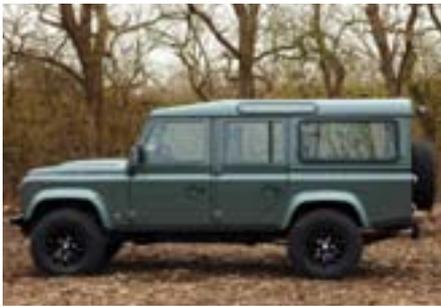
Diese hochstabile Land Rover-Leichtmetall-Felge im Military-Style hat die Abmessung 7 x 16 ET 20,6 und sorgt damit für eine Spurverbreiterung von 25 mm gegenüber den ab Werk montierten Felgen. Die Oberfläche ist schwarz glänzend. Die Lieferung erfolgt inkl. der Nabenkappe.
