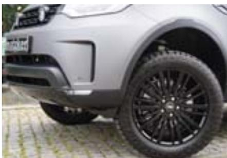
Einen sehr guten Kompromiss für die Bereifung des Discovery stellt die AT-Bereifung im 20-Zoll-Format dar. Der Reifen hat mit seiner 55%-Flanke eine gute Anpassungsfähigkeit im Gelände, fährt sich jedoch dabei nicht zu schwammig auf der Straße. Ebenso das Profil: als AT-Reifen ist z. B. der Goodyear Wrangler Duratrac sowohl auf der Straße als auch im Gelände gut einsetzbar. Insgesamt möchten wir diesen Radsatz jedem Fahrzeugnutzer, der regelmäßig die Straße verlässt, empfeh-
