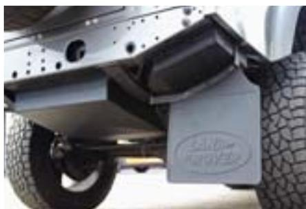
Als Erweiterung zum Longrange-Tank können wir diesen 36-Liter-Zusatztank anbieten, der zwischen Einfüllstutzen und Longrange-Tank als Durchlauf tank installiert wird. Es ergibt sich so ein Gesamtvolumen von 156 Litern. Der besondere Vorteil besteht in der optimalen Bedienungsfreundlichkeit, da beide Tanks durch einen Einfüllstutzen befüllt werden und keine Pumpen oder Umschalhähne erforderlich sind. Der Tank wird mit einem TÜV-Teilgutachten geliefert. Lieferbar für den De-
