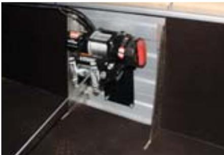
Insbesondere für den Einsatz in der Jagd, aber auch für sonstige Arbeitseinsätze montieren wir diese leistungsfähige Ladewinde mit einer Zugkraft von 900 kg. Zur Montage auf der Ladefläche wird eine Karosserieverstärkung aus Edelstahl eingebaut. Die Ausführung variiert je nach Fahrzeugtyp. Wir beraten Sie gern. Der Lieferumfang beträgt die Seilwinde, den Elektrosatz sowie die Karosserieverstärkung. Montage ab 75 AW.
