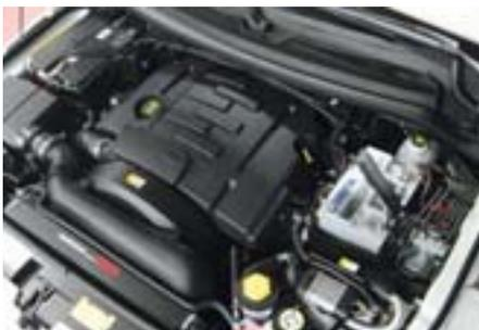
Moderne Fahrzeuge benötigen aufgrund der elektronischen Ausrüstung eine sehr leistungsfähige Stromversorgung. Sobald die Spannung leicht absinkt, ist ein Start nicht mehr möglich. Der Anlasser dreht dann zwar noch, die Bordrechner werden aber nicht ausreichend versorgt um hochzufahren. Als sichere Startreserve montieren wir eine zweite Starterbatterie geschützt im Motorraum. Sie ist über einen manuellen Hauptschalter im Motorraum getrennt und kann im Bedarfsfall zuge-
