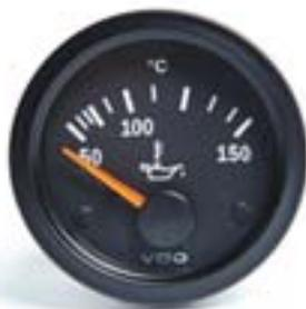
Dieses 52-mm-VDO-Rundinstrument passt sehr gut zur Defender-Instrumentierung. Es ist als Motoröl- oder Getriebeölthermometer einsetzbar. Der Anzeigebereich beträgt 50 bis 150 °C. Das Instrument ist sehr gut ablesbar und universell montierbar. Ein Geber für die Ölablassschraube des Motors ist im Lieferumfang enthalten. Ein Schrägstelling ist als Zubehör lieferbar. Bitte geben Sie uns bei einer Bestellung den Typ Ihres Land Rovers sowie die Fahrgestellnummer zur Bestimmung des
