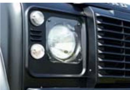
Die Makrolon-Scheinwerfer-Abdeckung ist ein Land Rover-Originalteil und schützt den Frontscheinwerfer vor Berührungsschäden und Temperaturreissen. Sie ist abnehmbar zur Reinigung des Scheinwerfers. Der Lieferumfang beträgt zwei Stück. Montage 9 AW.
