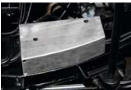
Der Kraftstoffkühler ist beim Defender TD4 ungeschützt hinter der Vorderachse links am Fahrgestell montiert. Der Anschluss der Kraftstoffleitungen besteht aus Kunststoff-Schnellverschlüssen. Damit ist dieses Bauteil sehr anstoßgefährdet. Für den Geländeeinsatz empfehlen wir deshalb dringend das Kraftstoffkühler-Schutzgehäuse. Es ist passgenau aus Leichtmetall hergestellt, folgt der Rahmen-Bauform und wird an den vorhandenen Verschraubungen des Kraftstoffkühlers befestigt.
