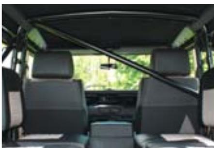
Für den Defender 90/110 Soft Top bieten wir den Sicherheitsbügel nach Militärstandard an. Er besteht aus dem Hauptbügel, der hinter den Sitzen montiert und in den vorderen Ecken der Ladefläche mit soliden Verstärkungen befestigt wird. Zwei Stützstreben verlaufen in einem Winkel von 45 Grad zur Stahl-Abschlussleiste der hinteren Karosserie. Der Bügel verfügt über Aufnahmen für den Sicherheitsgurt und besteht aus nahtlos gezogenem Stahlrohr (schwarz pulverbeschichtet). Be-
