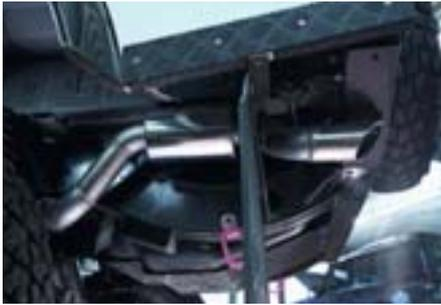
Für sämtliche Defender-Modelle bieten wir eine Edelstahl-Abgasanlage an. Es werden durch den Einbau mehrere Vorteile erzielt: Die Haltbarkeit des Materials ist fast unbegrenzt und der Auspuff-Rost entfällt. Das Design der Anlage vergrößert die Bauchfreiheit, da wir den Hauptschalldämpfer kleiner gestalten und höher positionieren. Das Endrohr ist geländetauglicher gestaltet. Das Gewicht wird um bis zu 14 kg reduziert. Die Anlage ist strömungstechnisch überarbeitet, sodass ein Vorteil
