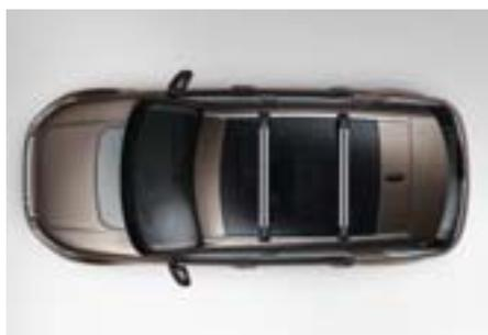
Das T-Schienen-Design der Querträger nutzt die volle Länge der Träger und bietet so viel Platz zur Montage verschiedener Zubehörteile. Die Querträger sind sehr robust und zudem abschließbar. Das aerodynamische Profil sorgt für einen geringeren Luftwiderstand und somit für minimierte Fahrgeräusche. Es handelt sich um ein originales Land Rover-Zubehörteil. Voraussetzung zur Montage der Dachquerträger ist die Dachreling.
