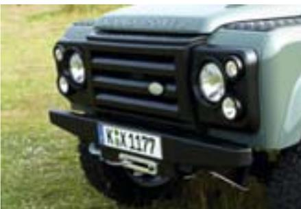
Die integrierte Seilwinde ist absolut leistungsfähig und leicht bedienbar. Hinter dem Stoßfänger wird eine Stahlkonsole zur Aufnahme der Winde eingebaut. Sie ist entsprechend dimensioniert und verstärkt den Frontbereich des Fahrgestells. Günstig ist diese Einbaulage auch, da die Hebelwirkung des Mehrgewichts auf die Federung geringer ausfällt als bei einer Montage vor dem Stoßfänger. Die Warn-Seilwinde mit einer bärenstarken Zugleistung von 5.400 kg ist mit einem 25 Meter
