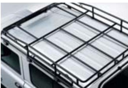
Original Land Rover-Dachgepäckträger. Länge wahlweise 1.600 mm für Defender 90 oder 1.400 mm für den Defender 130 Crew Cab. Der Dachgepäckträger ist aus rundem Stahlrohr gefertigt. Dadurch sind die Windgeräusche geringer und es besteht keine Beschädigungs- und Verletzungsgefahr beim Beladen. Die Qualität der Stahlrohre ist so hoch, dass der Träger mit ca. 27 kg ein geringeres Eigengewicht als vergleichbare, kleinere Produkte aus Leichtmetall aufweist. Stahl ist jedoch
