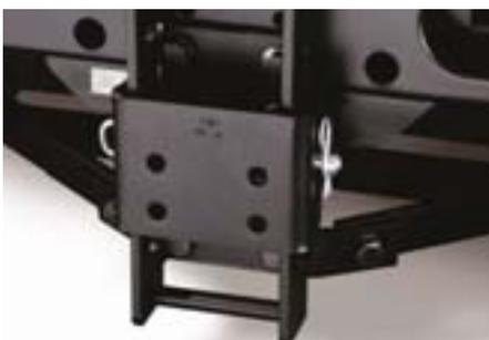
Bei dieser Anhängerkupplung kann mittels eines Verschiebeschlittens die Höhe der Kugel über einen weiten Bereich eingestellt werden. So kann die Kupplung auch für unterschiedliche Anhängertypen wie z. B. Tandem- oder Soloachsen auf eine optimale Balance eingestellt werden. Wir liefern dieses Land Rover-Originalteil mit Montagematerial und passendem Elektrosatz. Es verfügt über eine europäische Betriebsgenehmigung und muss deshalb nicht vom TÜV abgenommen
