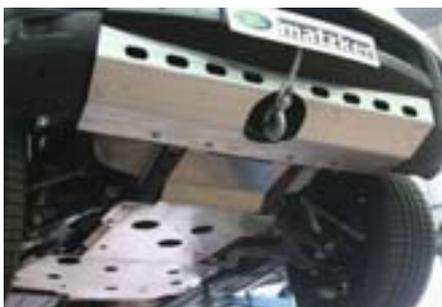
Die Leichtmetall-Panzerung des Unterbodens schützt den Motor, die Vorderachse sowie die Getriebeeinheit zuverlässig vor Beschädigungen im Gelände. Sie ist dreiteilig und besteht aus 6 mm starkem Flugzeug-Aluminium. Diese wichtige Offroad-Ausrüstung ist nicht nur bei unübersichtlicher Flussschiffahrt unerlässlich. Bitte geben Sie uns bei einer Bestellung den Typ und das Baujahr Ihres Range Rover Sports an. Montage 49 AW.
