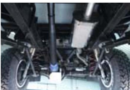
Das Kreuzgelenk am hinteren Differential ist besonderen Belastungen ausgesetzt, denn es befindet sich im Bereich des von der Vorderachse aufgewirbelten Schmutzes. Auch bei Fahrten in tiefem Schlamm wird es regelrecht durch den Schlamm gezogen. Die Nadellager des Kreuzgelenkes sind zwar hochbelastbar, bei Schmutzeintrag können jedoch schnell Schäden auftreten, insbesondere auf langen Offroad-Touren, auf denen ein Abschmieren unterwegs nicht möglich ist. Ein solcher Schaden ist problema-
