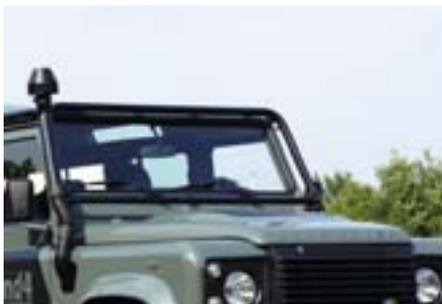
Dieser hochgesetzte Lufteinlass ist aus schwarz beschichtetem Stahlblech in Land Rover-Originalform hergestellt. Er hat einen speziell geformten Anschluss-Stutzen für das Kotflügelblech, um mit der Montage eines Sicherheitskäfigs zu harmonisieren. Die Befestigung der vertikalen Luftführung erfolgt am Bügelrohr. Im Filterkopf ist ein wartungsfreier Zentrifugalabscheider integriert. Hochgesetzte Vorfilter verlängern die Standzeit des Luftfilters erheblich, nicht nur wegen der zusätzlichen
