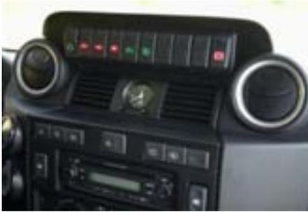
In unserem Armaturengehäuse können neun hochwertige Schalter von Hella eingebaut werden. Es ist eine Vielzahl von elektrischen Schaltfunktionen und Schaltersymbolen lieferbar. Zudem gibt es die Schalter als Taster, mit Betätigungssperre sowie mit Auffind- und Funktionsbeleuchtung. Es können also sämtliche Zusatzfunktionen bedient werden. Der Lieferumfang umfasst das Gehäuse, einen Einbauahmen sowie die Schalter. Montage nach Aufwand.
