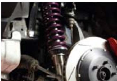
Dieses Fahrwerk ist für den Motorsport oder Expeditionseinsatz mit dem Discovery konstruiert. Basierend auf dem Stahlfederfahrwerk kommen Hochleistungs-Stoßdämpfer mit enormen Belastungsreserven zum Einsatz. Der blockfeste Federnsatz ist auf das maximale Fahrzeuggewicht von 3.300 kg ausgelegt. Das Gewindefahrwerk kann auf den Einsatz oder die verwendete Reifengröße bezüglich der Fahrhöhe eingestellt werden. Auch ein vollbeladener Discovery kann so
