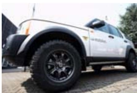
Der Schwellerschutz ist eine passgenaue Verkleidung des Schwellers vom Discovery aus 5 mm starkem Flugzeug-Aluminium. Die Oberfläche ist schwarz pulverbeschichtet. Der Schwellerschutz wird anstatt der Kunststoffblende montiert. So entstehen keine Schäden, wenn das Fahrzeug im Gelände aufsetzt oder berührt wird. Er bietet auch einen zusätzlichen Seitenaufprallschutz. Der Preis bezieht sich auf ein Paar. Montage 24 AW.
