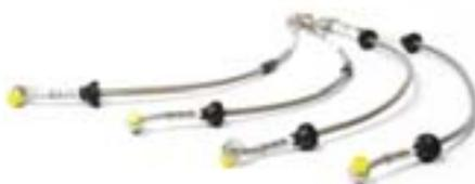
Die serienmäßig verbauten Gummi-Bremsleitungen mit Gewebeverstärkung dehnen sich bei einem entsprechenden Druckanstieg aus, was eine Reduzierung des Bremsdrucks zur Folge hat. Im Pedal ist ein schwammiges Gefühl feststellbar. Die hochwertigen Stahlflex-Bremsleitungen sind durch den Aufbau mit einer inneren Teflon-Leitung, die von Edelstahlgewebe ummantelt ist, dehnungsresistent und extrem druckfest. Durch den Einbau wird der Druckpunkt präziser und das Bremsgefühl
