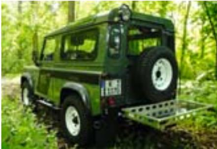
Das Ranger-Paket beinhaltet die wichtigsten Ausrüstungen für den Jagdeinsatz und den Schutz des Fahrzeugs. Der stabile Aluminium-Front-Unterfahrerschutz und die Metall-Lampenschutzgitter vorne und hinten verhindern Schäden bei Fahrten im Gelände. Die Gummi-Fußmatten vorne und hinten, die waschbaren und wasserfesten Sitz-Schonbezüge für Fahrer und Beifahrer sowie die Laderaumwanne schützen den Innenraum vor Verschmutzung und Verschleiß. Die außen am Fahr-
