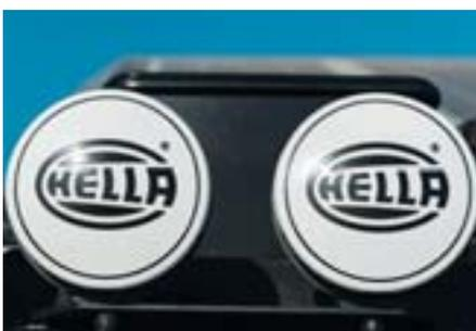
Die meisten Zusatzscheinwerfer verfügen über ein Druckguss-Gehäuse, dass vor Spritzwasser und Staub schützt. Das Gehäuse erhöht die Lebensdauer der Scheinwerfer. Da die Beleuchtungseinheiten bei Geländefahrten äußerlich dennoch rasch verschmutzen und hiernach keine ausreichende Leuchtkraft mehr abzurufen ist, bieten wir für jegliche Scheinwerfer aus unserem Portfolio, zusätzlich robuste Schutzabdeckungen, welche vor Schmutz und Steinschlägen schützen. Bit-
