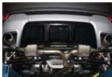
Die Performance-Abgasanlage für den Evoque Diesel sorgt für einen möglichst geringen Abgas-Gegendruck. Sie ist akustisch abgestimmt und mit dem Einbau entsteht ein angenehm tiefes, jedoch nicht aufdringliches, Abgasgeräusch. Die zweiflutige Anlage besteht aus 65-mm-Edelstahlrohr. Montage 18 AW.
