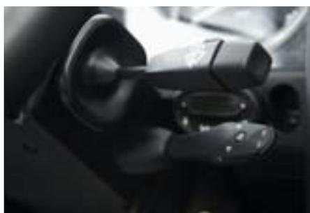
Die elektronische Geschwindigkeits-Regelanlage für den Defender TD4 2.2 und 2.4 erlaubt das Halten, Beschleunigen oder Verlangsamen der Geschwindigkeit durch manuelle Einstellung an der Bedieneinheit. Das ist besonders auf langen Fahrten sehr entspannend, da der rechte Fuß nicht am Gaspedal benötigt wird. Mit der Reset-Funktion kann die zuletzt gespeicherte Geschwindigkeit nach einem Bremsvorgang wieder eingestellt werden. Die Bedienung erfolgt über einen form-
