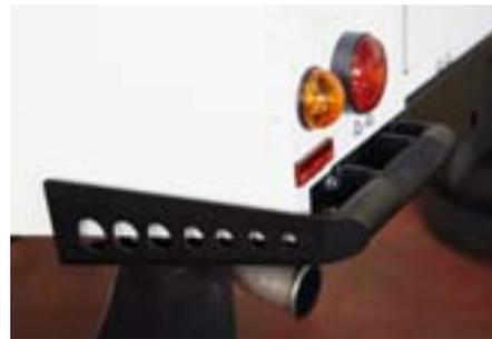
Der Eckschutz ist ein robustes Stahlteil und schützt die empfindlichen Bereiche der hinteren Seitenwand und des Eckprofils der Karosserie bei einem Anstoß. Er wird am soliden Rahmenendträger des Fahrgestells verschraubt und umschließt den Eckbereich sowie die Unterkante der Seitenwand. Dieses Bauteil ist nicht für den Einsatz im Geltungsbereich der StVZO geeignet. Montage 10 AW.
