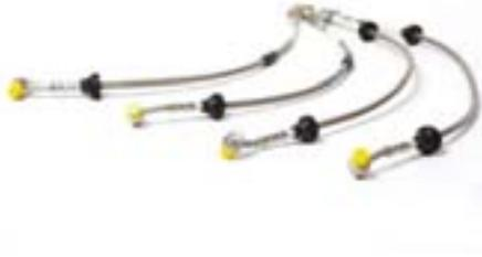
Diese Teflon-Bremsleitungen mit Edelstahl-Ummantelung sind extrem robust. Deshalb empfehlen wir sie für Fahrzeuge, die besonderen Belastungen ausgesetzt sind wie z. B. im harten Offroad-Einsatz oder auf Fernreisen. Zudem sind sie druckstabiler und verbessern so das Bremsgefühl. Land Rover empfiehlt, die serienmäßigen Bremsschläuche nach vier Jahren oder 80 Tkm Laufleistung zu erneuern, dies ist eine gute Gelegenheit, die Stahlflex-Leitungen zu montieren. Der
