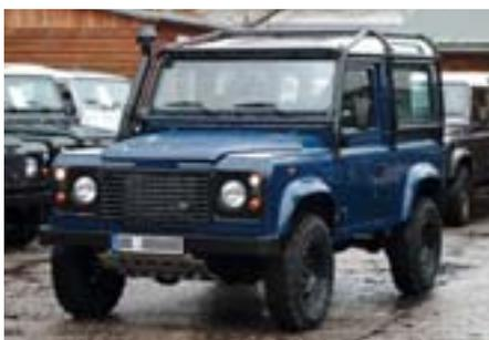
Einen besonders guten Insassen- und Fahrzeugschutz bietet der Full-External-Roll-Cage, der außenliegende Komplettkäfig. Die sechsfache Abstützung auf dem Fahrgestell im Bereich der A-, B- und C-Säulen schaffen höchste Stabilität und einen hervorragenden Insassenschutz ohne den Innenraum einzuschränken. Halterungen für Scheinwerfer und eine Gepäckablage sind vorgesehen. Durch den Einbau werden Luftwiderstand und Windgeräusche leicht erhöht. Es kann in Verbindung
